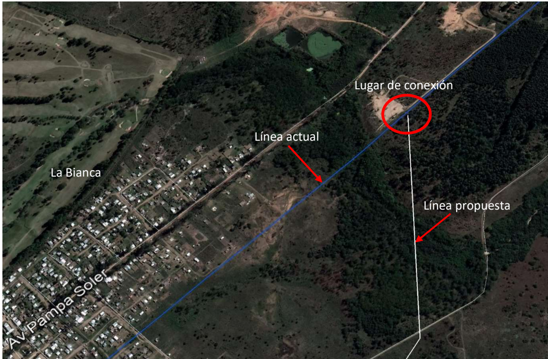
Fig. 2—2. Lugar de empalme con línea actual.
