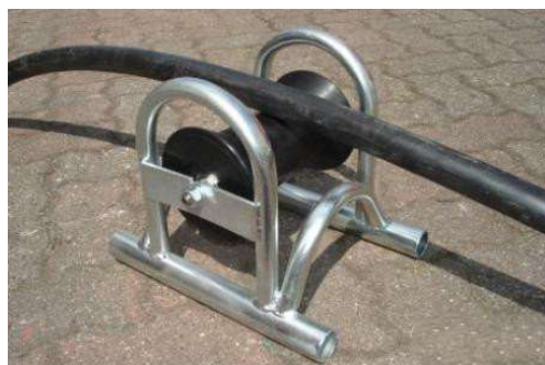
Fig. 2—5. Rodillos para tendido de cable.
