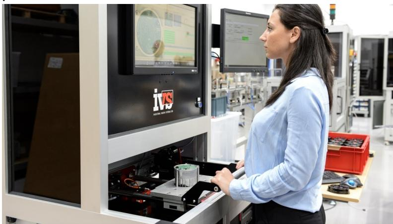
*Fig. 5. Inspección automática de placas*
