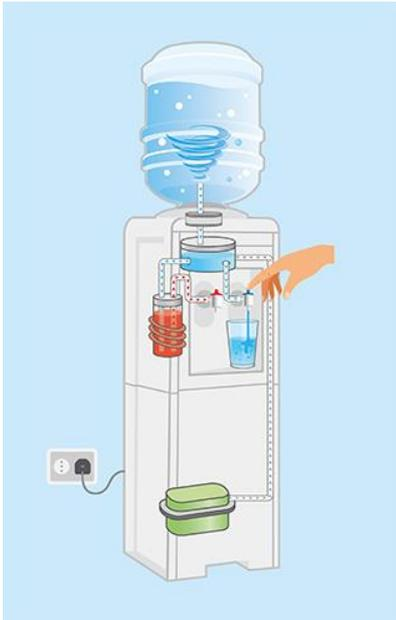
Cuando el bidón se coloca en la máquina, se agujerea la boca del mismo y se permite la entrada del agua a la máquina gracias al efecto de la gravedad. Cuando se aprieta el botón, el dispensador de agua libera el aire que iniciará la distribución de agua. El agua sustituye el espacio vacío en el bidón, esta es la razón por la cual cuando se usa este tipo de dispensador se forman grandes burbujas de aire dentro del mismo.
