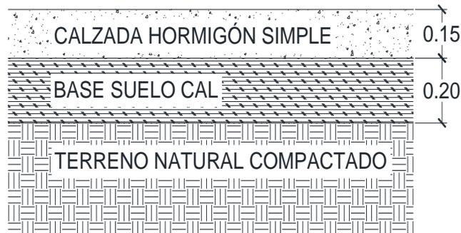
**Figura 2.3.:** Paquete estructural para calzada de hormigón en tránsito pesado
