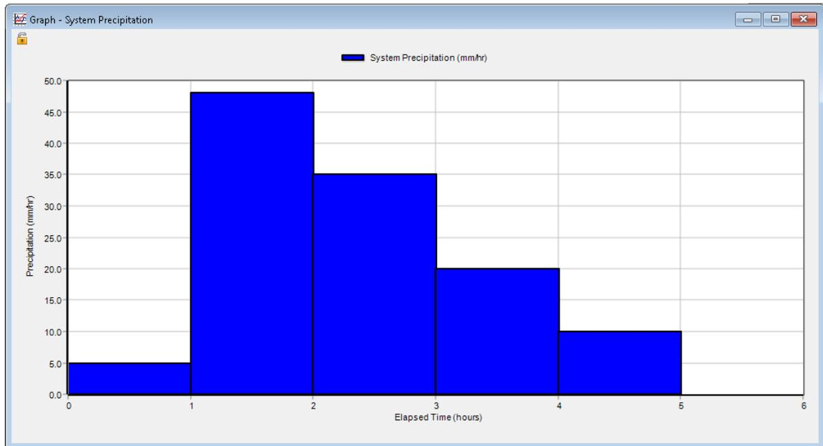
**Figura 3.4:** Hietograma obtenido en software SWMM para tormenta real
