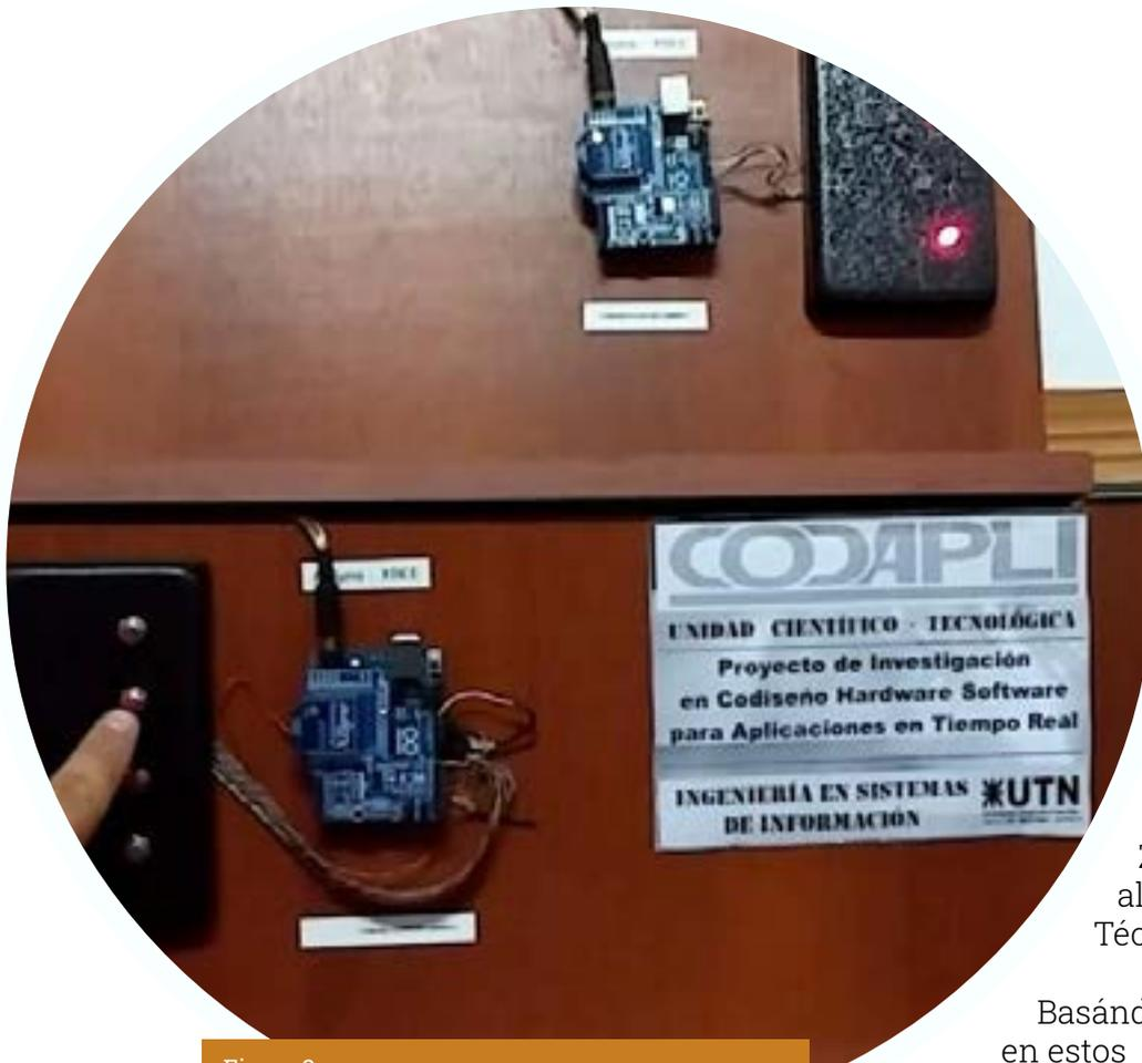
Figura 2. Prototipo de sistema transmisor-receptor con módulos XBee desarrollado en CODAPLI.
