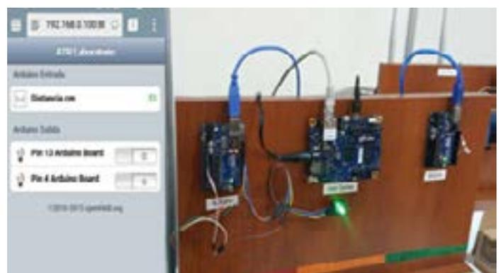
Figura 3. Aplicación móvil para toma de datos y control de dispositivos físicos mediante combinación de placas Arduino-Intel Galileo.
