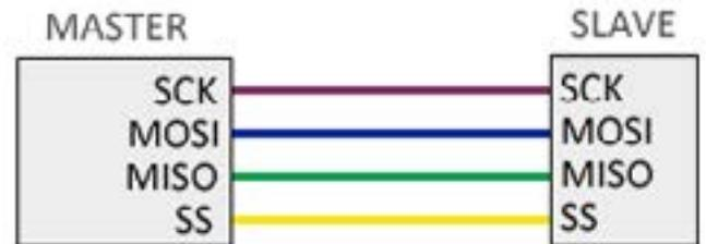
Figura 10. Líneas necesarias para establecer una conexión SPI full-duplex
