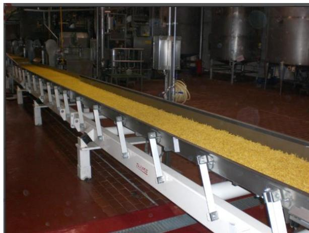
Figura 18. Sistema de transporte por vibración.
