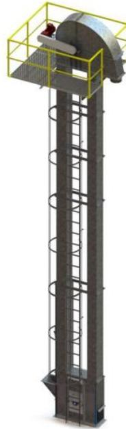
*Figura 15. Sistema de transporte de elevador a cangilones.*
