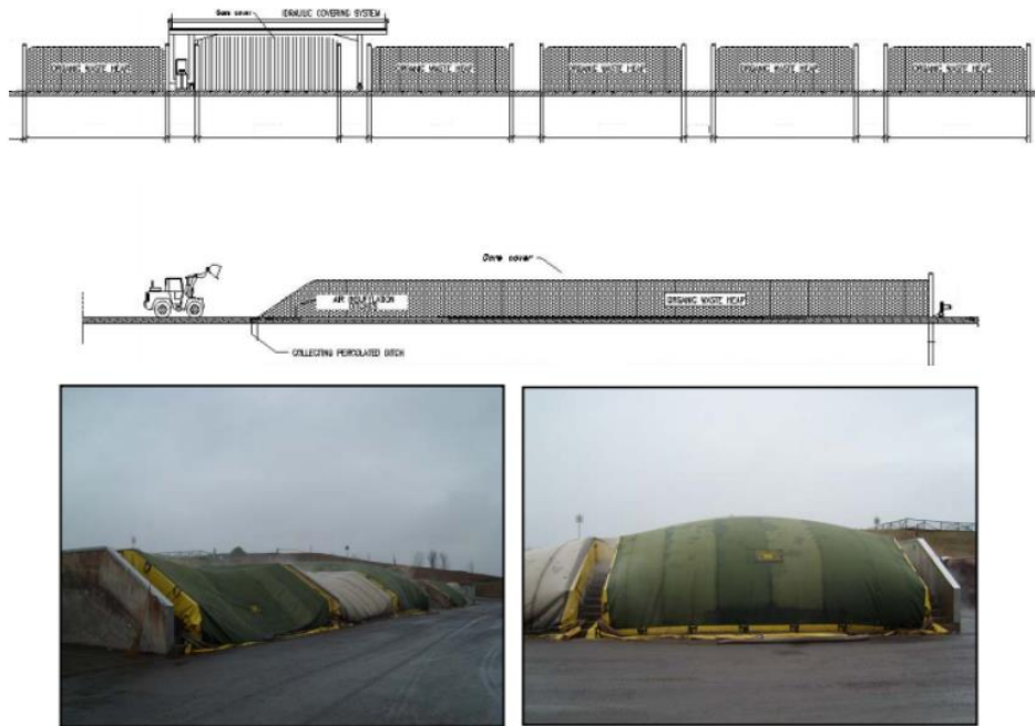
Gráfico 5: Túneles de Bioestabilización (Roggio, R. (2011), EIA- Proyecto de tratamiento y reducción de RSU- Planta de TMB- CEAMSE)
