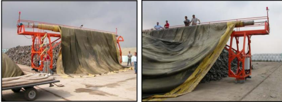
Gráfico 8,9: Carretes (Roggio, R. (2011), EIA- Proyecto de tratamiento y reducción de RSU- Planta de TMB- CEAMSE)
