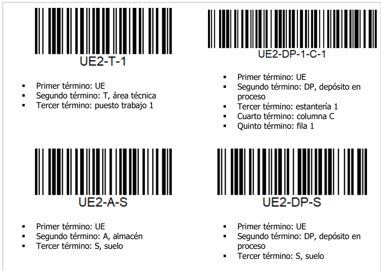
Figura 8.2.3-2: diseño del CBr en puestos de trabajo, en estanterías de área técnica y sector suelo almacén.
