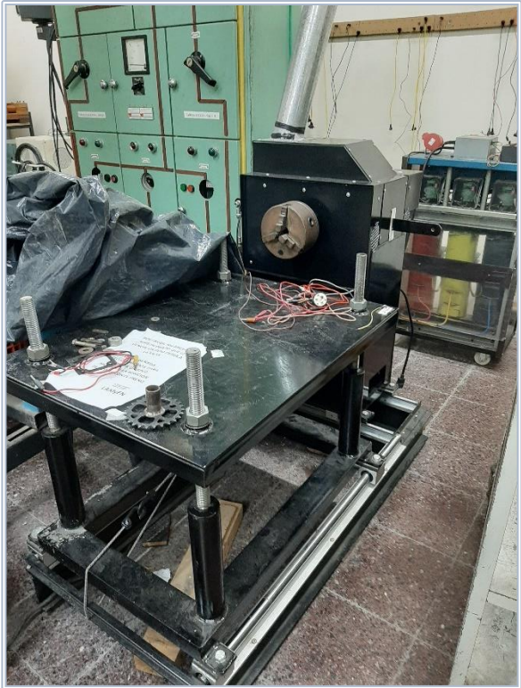
Figura ANEXO 4.1-9: equipo freno de 30 [Kw]. Fuente: elaboración propia.
