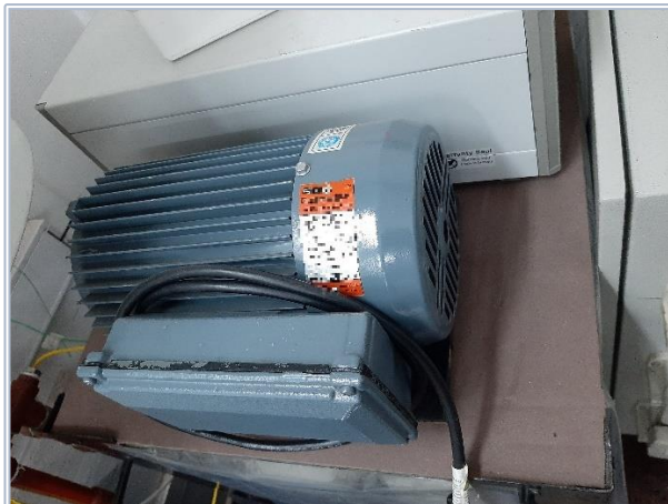
Figura ANEXO 4.1-5: muestra, motor de inducción. Fuente: elaboración propia.
