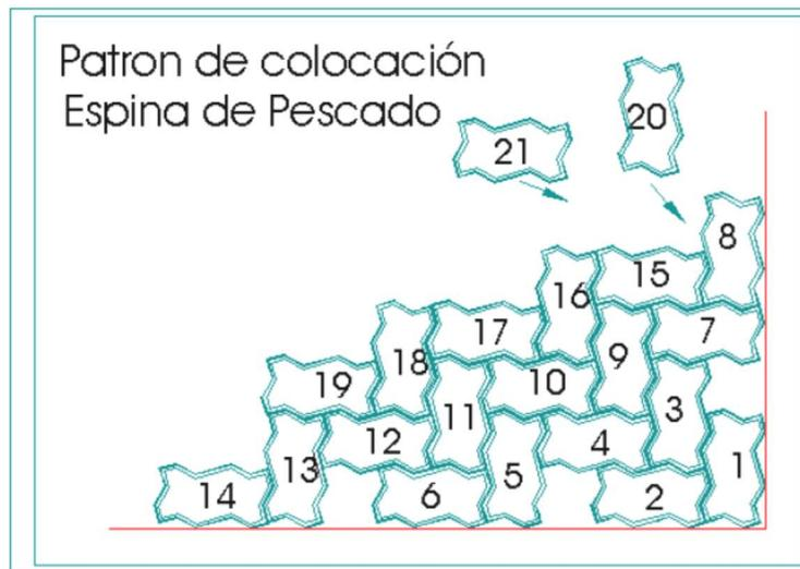
En tramos rectos el ancho de juntas entre adoquines no excederá los 5 mm., en tramos curvos se podrá llegar a 10 mm. Si alguna área de adoquines mostrara juntas abiertas excediendo los valores antedichos, o juntas no uniformes, será desmontada y vuelta a ejecutar en la forma correcta.
