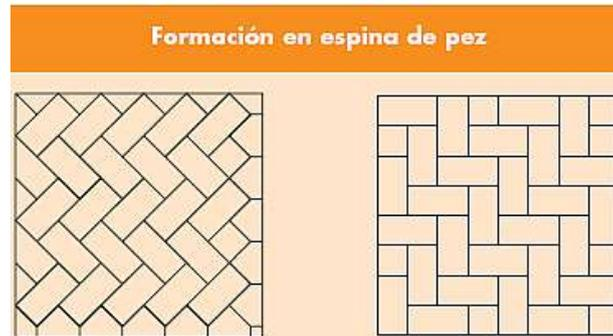
**Figura 10 - Disposición de Adoquines.**
