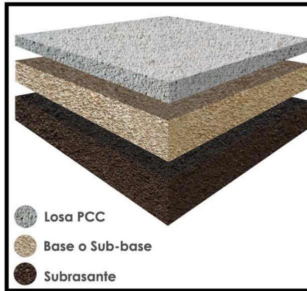
*Figura 194 - Capas pavimento rígido.
