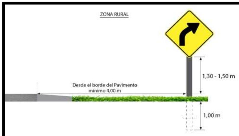
*Figura 275 - Disposición de la señalización vertical con respecto a la calzada
