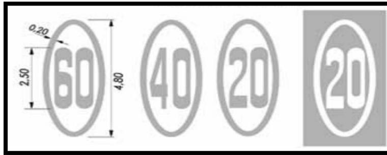
Figura 287 - Símbolo de Velocidad Máxima para velocidades de hasta 60 km/h.
