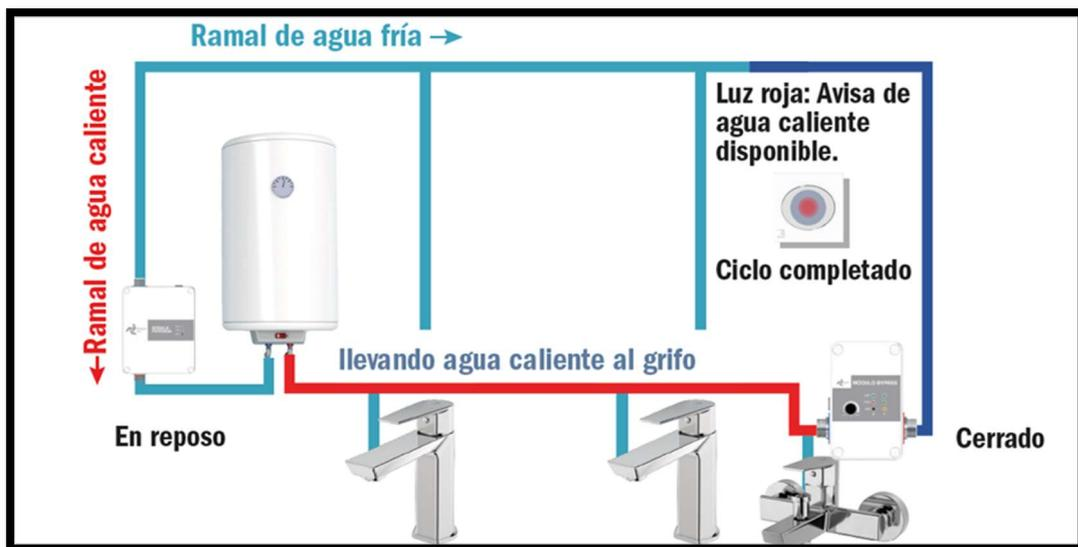
Figura 157 - Esquema sistema agua caliente.
