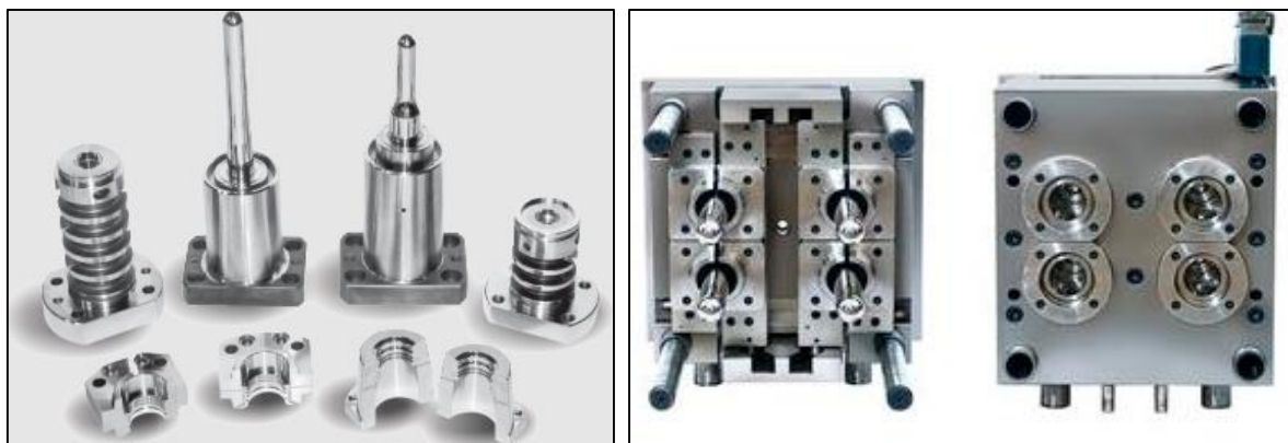
Imagen 8.1 - Cabezales, cuerpo y moldes de inyectoras
