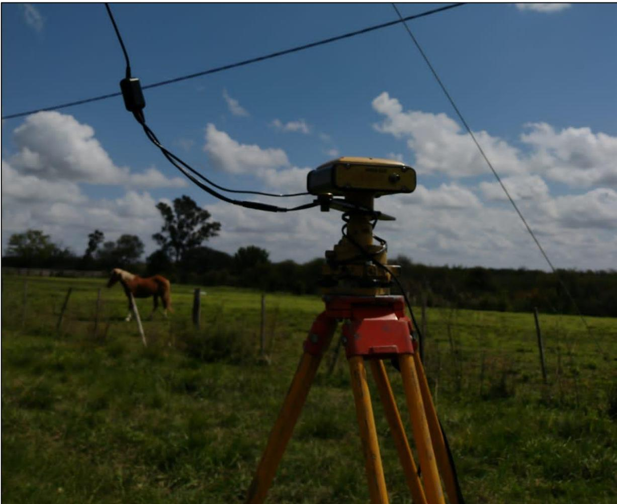
*Figura 4.1: Antena de sistema GPS.*
