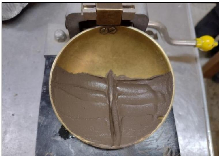
*Figura 5.10: Ensayo de límite líquido.*
