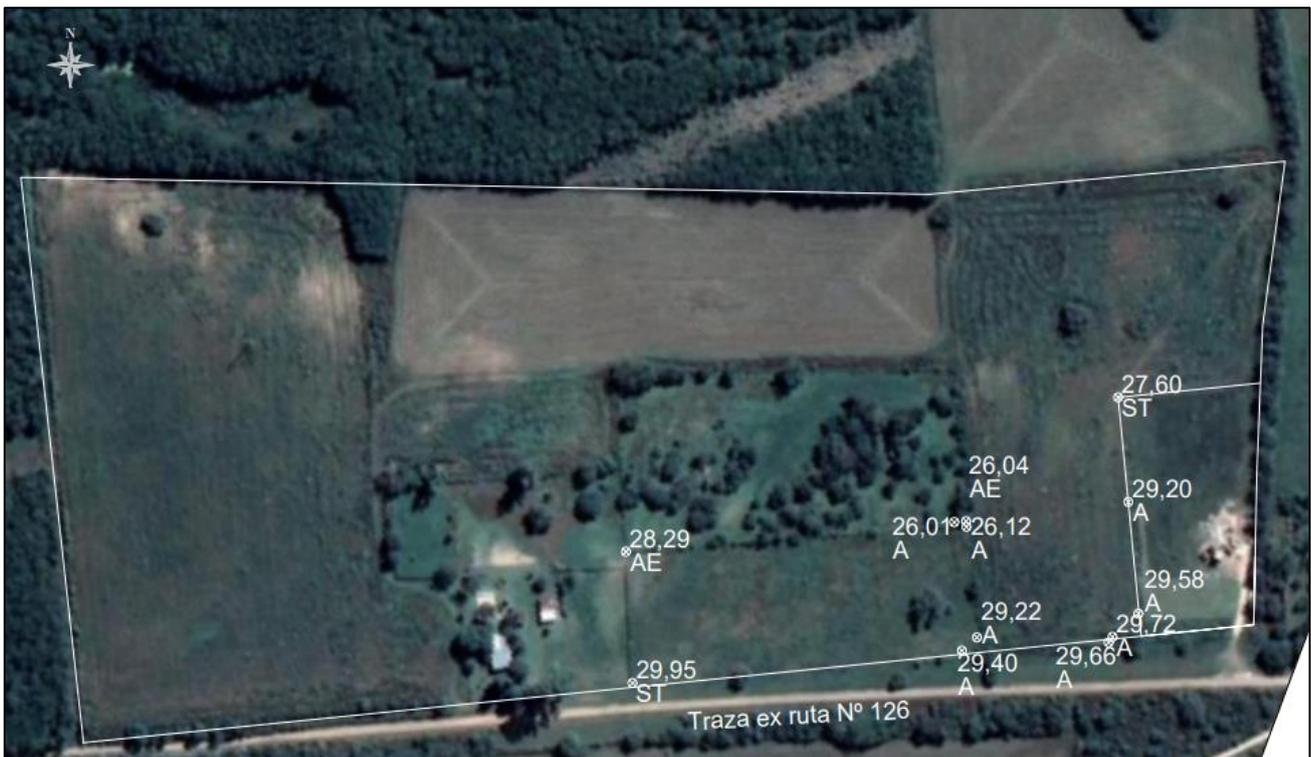
*Figura 4.4: Puntos fijos y de alambrado para ubicación de mensura.*
