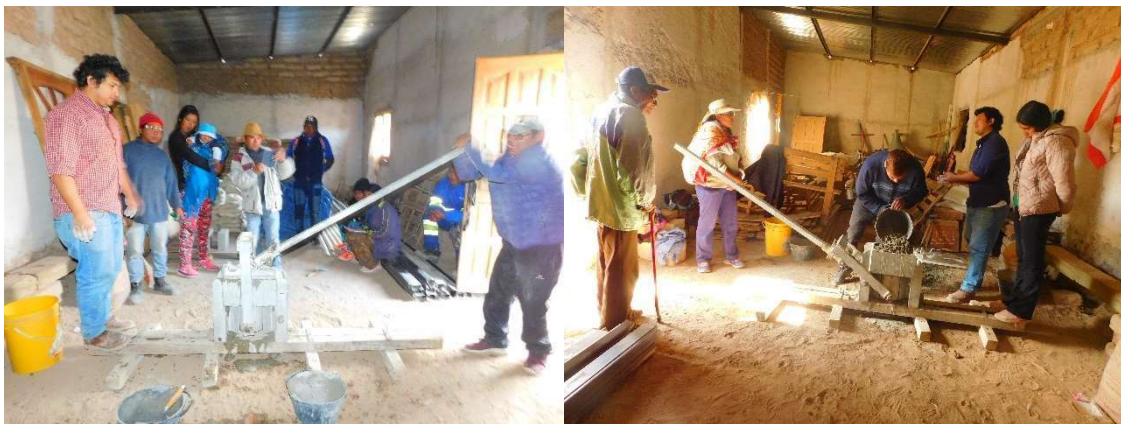
Figura 7.4 Los integrantes de la comunidad fabricando los mampuestos
