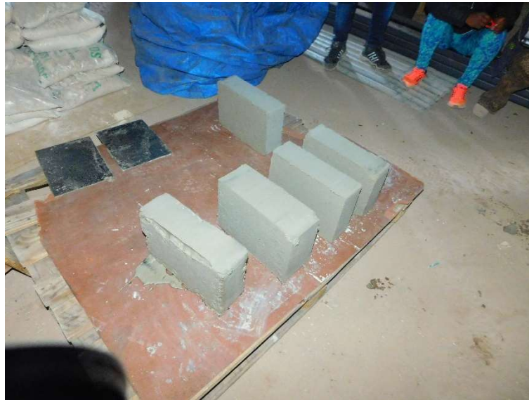
Figura 7.5 Primeros mampuestos elaborados in situ
