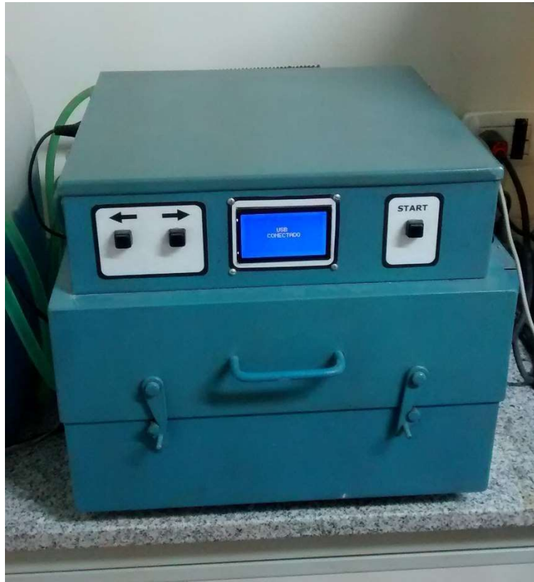
Figura 4.15 Equipo para determinar la conductividad térmica
