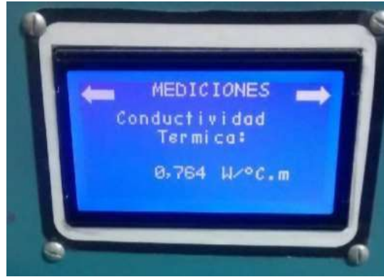
Figura III.6 Equipo muestra resultado de Conductividad Térmica
