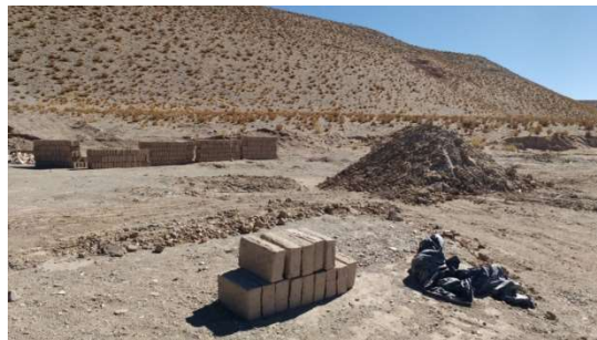
Figura III.1 Producción de adobes en San Antonio de los Cobres
