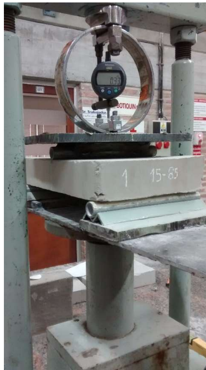
Figura 4.10 Prensa para realiza el ensayo a la flexión
