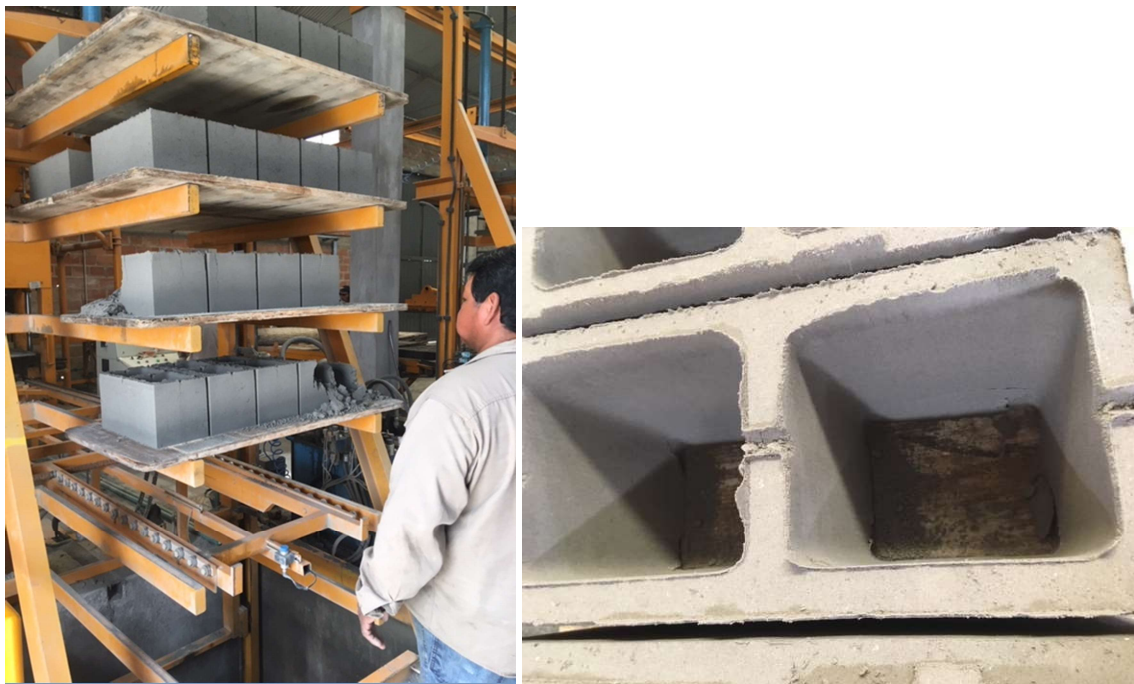
Figura II.4 Acopio y terminación de los bloques
