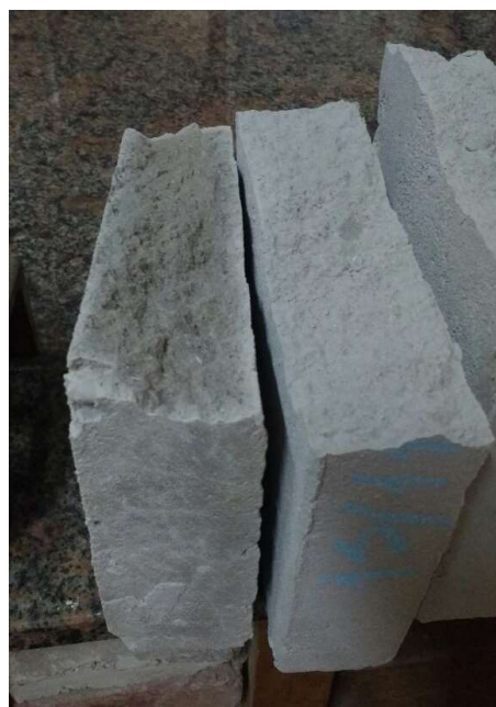
Figura 5.6 Diferencia entre un ladrillo humedecido (izquierda) y uno seco (derecha)
