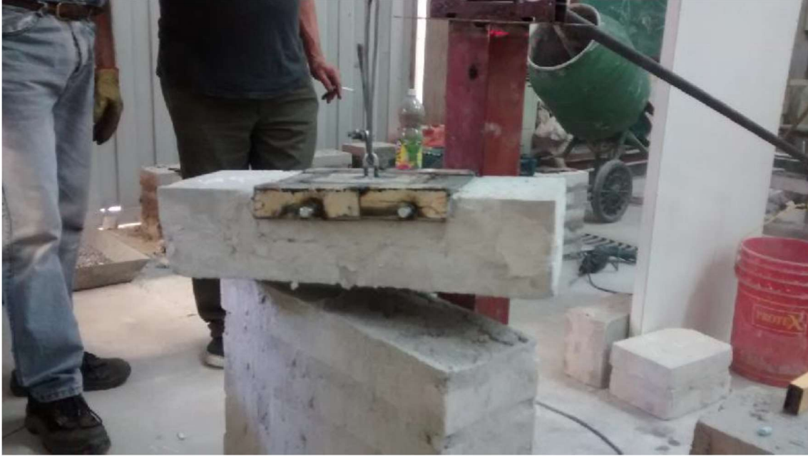
Figura 4.18 Murete de ladrillos de perlita ensayado a tracción
