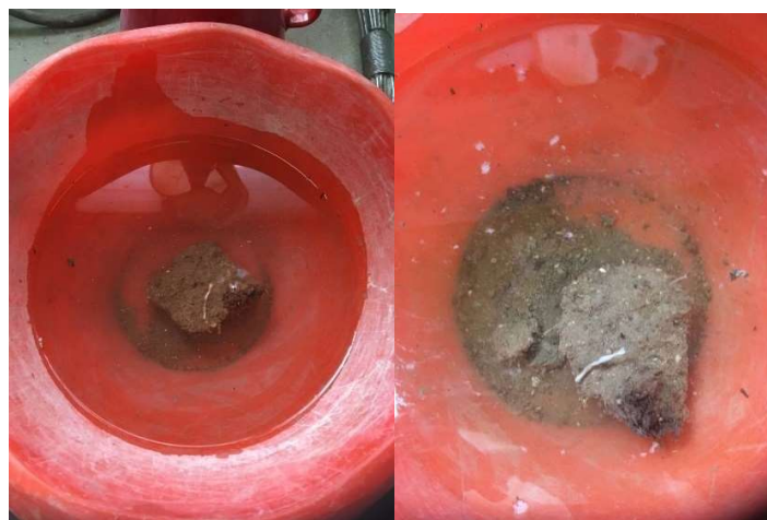
Figura III.5 Probetas de adobes en agua
