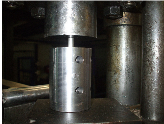
Figura 9: Operación de compactado.
