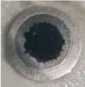
Figura 26: Muestra de compuesto con porosidad radial preparada para estudio metalográfico.
