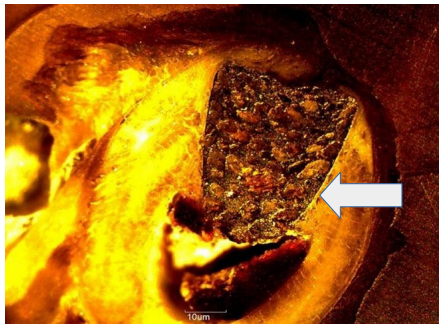
Figura 38: Implante Ti poroso (indicación flecha blanca) en contacto con hueso.
