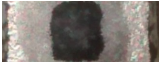
Figura 27: Muestra metalográfica de compuesto con porosidad radial. Corte transversal.
