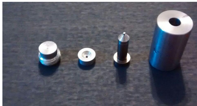
Figura 12: Matrices usadas para la fabricación de implante para ratas.
