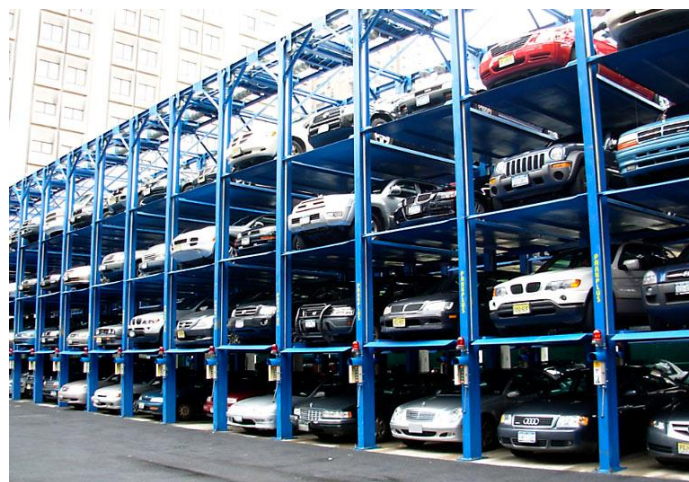
Figura 3.2: Estacionamiento semiautomático dependiente.
