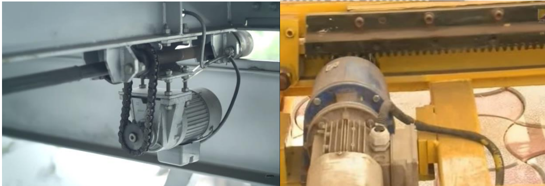
Figura 4.2: Sistema de ruedas motrices y cremallera.
