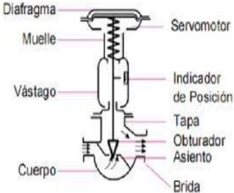
Ilustración 52 - Esquema de una válvula de expansión.
