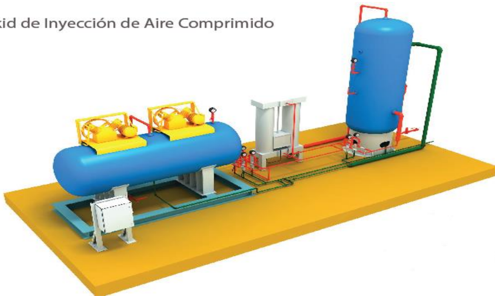
Ilustración 66 - Esquema de un skid de aire para instrumentos.
