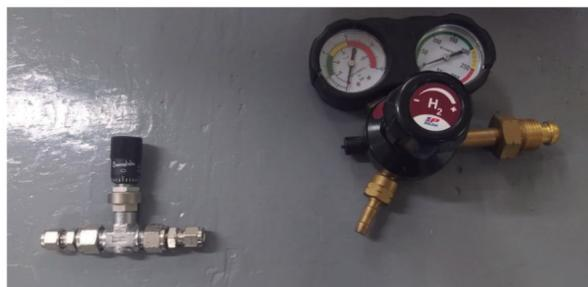
Fig. 7. De izquierda a derecha, válvulas reguladoras de caudal y presión
