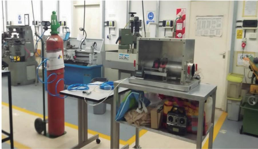
**Fig. 8. Línea de inyección de hidrógeno**
