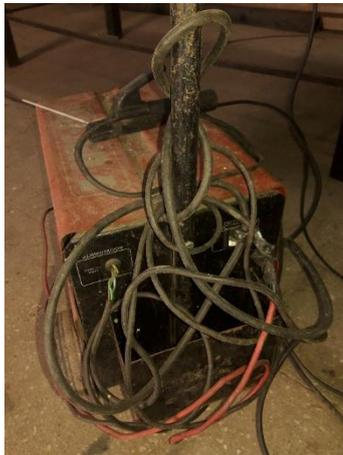
*Nota: Los cables se encuentran estado regular, están empalmados y aislados con cinta aisladora, en la parte de la salida del cable hay cables expuestos sin la vaina protectora.*
