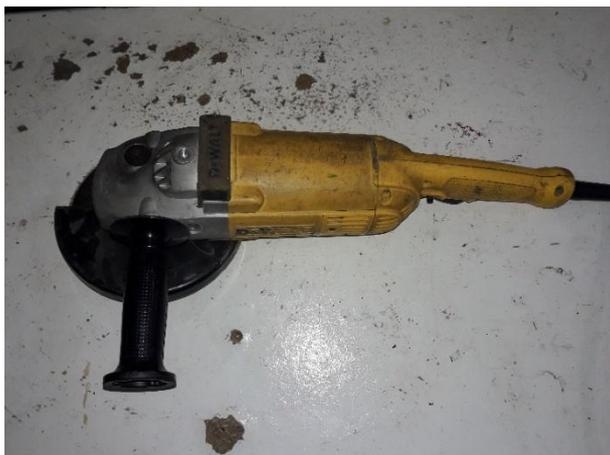
*Nota: Las condiciones del mango y la protección fija están en buen estado.*
