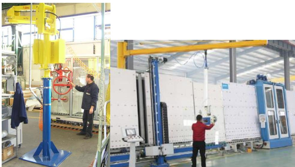
➤ Sistema de elevación por vacío tipo puente grúa
