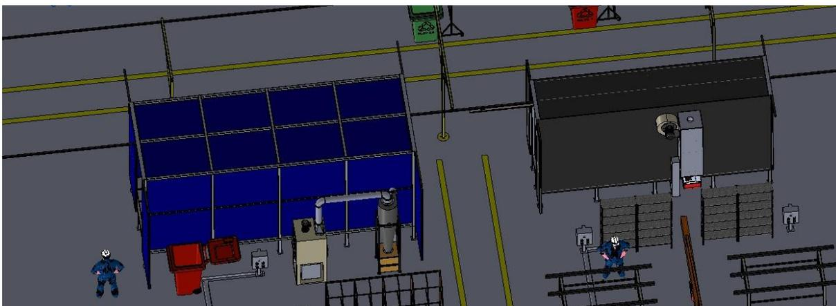
*Imagen 84 - Área de pintura en polvo y horno de curado - línea compartida*
