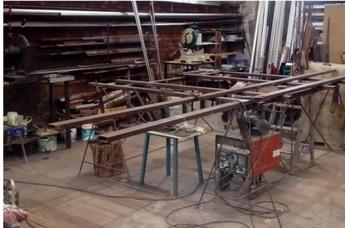
*Imagen 20- Mesa armado y soldadura*
