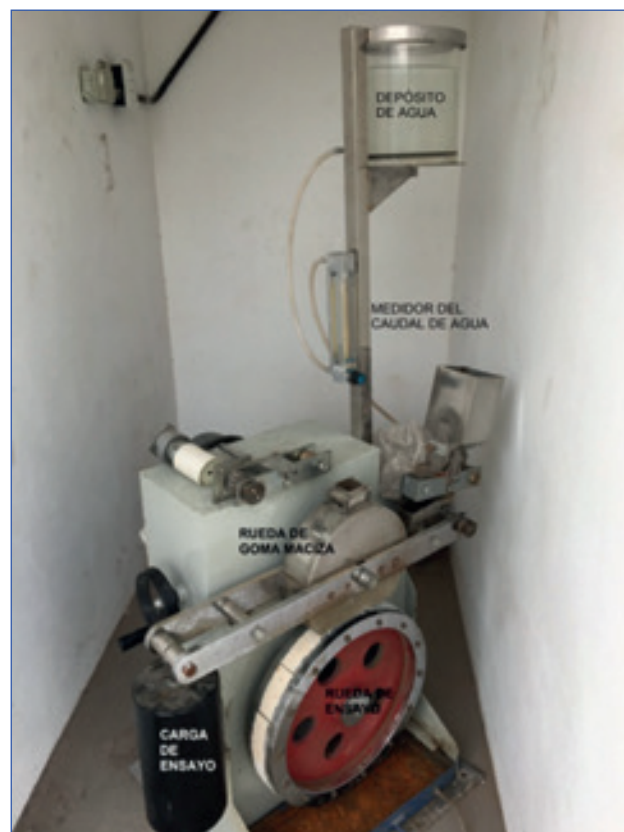
Figura 3. Equipo de Pulimento Acelerado de Áridos del LEMaC (Fuente: elaboración propia).
