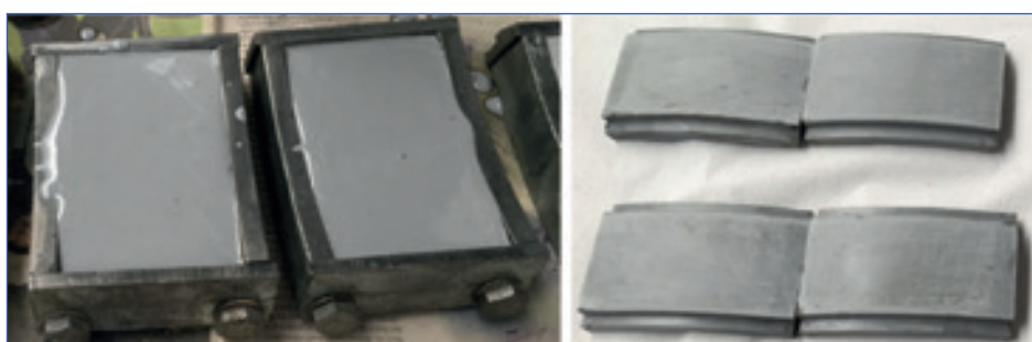
Figura 4. Confección de los sustratos de las muestras (Fuente: elaboración propia).
