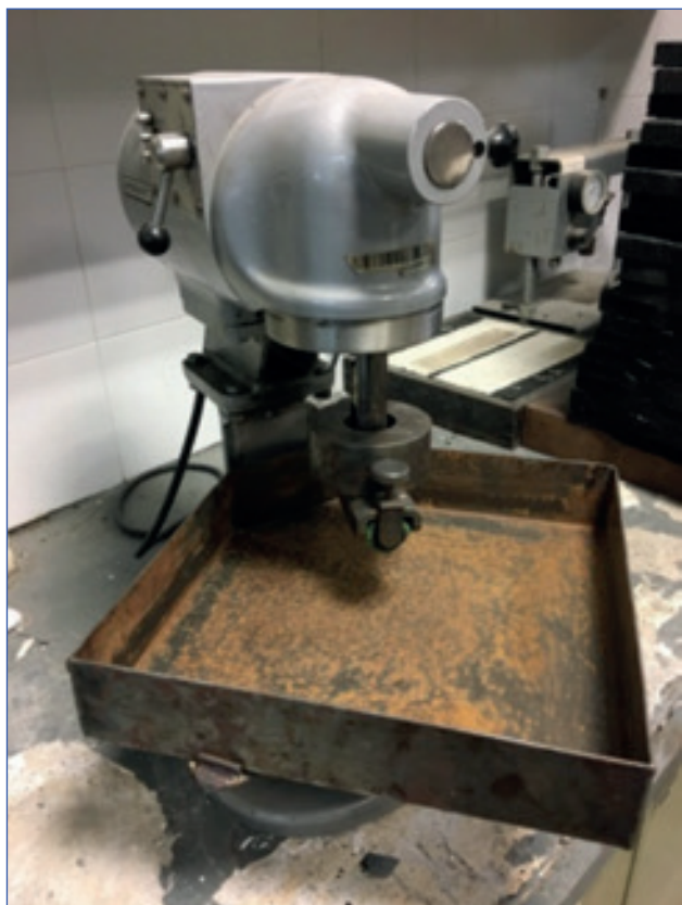
Figura 5. Equipo WTAT del Centro LEMaC (Fuente: elaboración propia).
