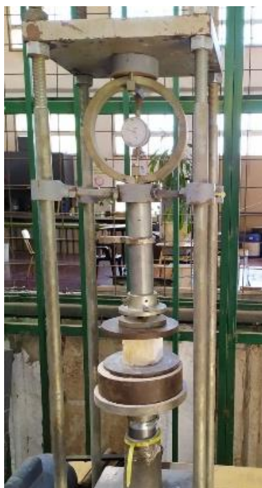
Figura 32: Realización del ensayo de resistencia a compresión sobre una probeta de la serie P-30. Fuente: Elaboración propia.
