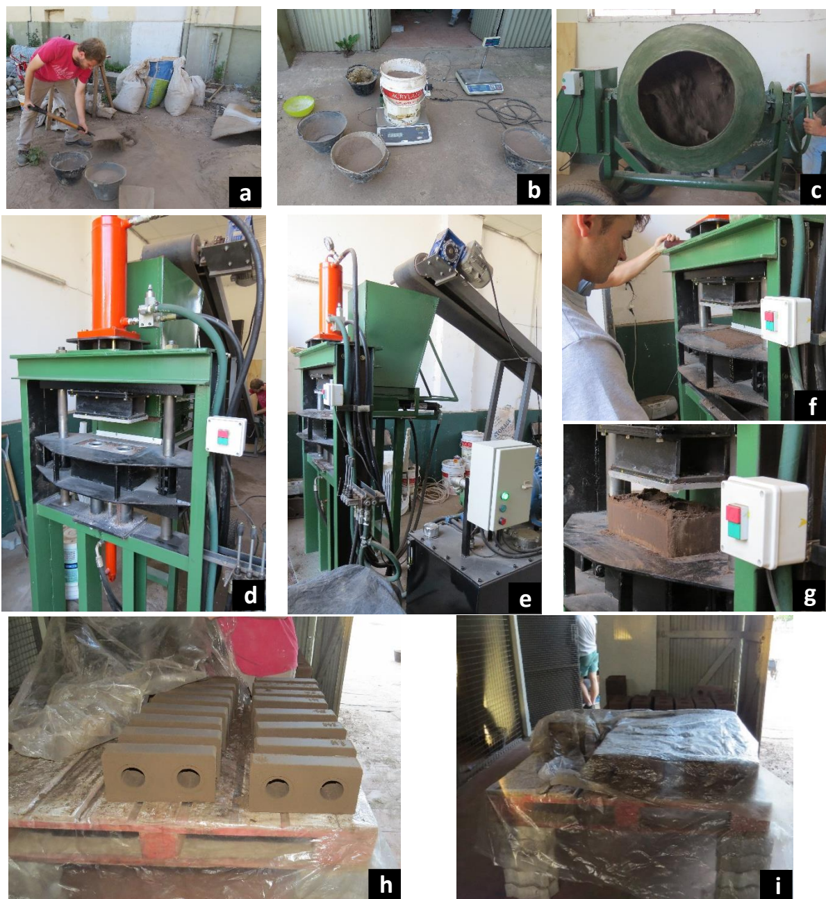
Figura 35: Proceso de fabricación de BTC en la planta de Eco3 Ingeniería. a) y b) Dosificación en peso de la materia prima, c) mezclado en seco de la materia prima d) y e) vista frontal y lateral de la prensa y cinta transportadora empleadas en la fabricación de los BTC. f) y g) Prensado de un bloque, h) acopio de BTC para ser curados e i) envoltura de los BTC húmedos con un film de polietileno para favorecer su curado.
