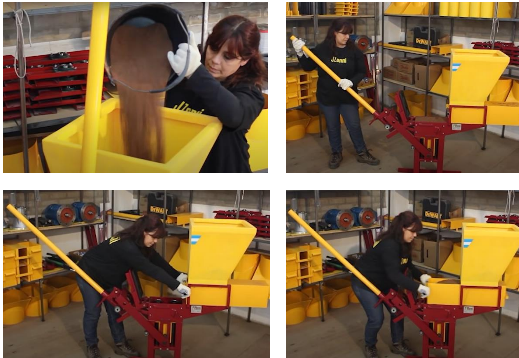
Figura 126: Proceso de carga por volumen de una prensa manual. Fuente: Elaboración propia a partir de la página web del fabricante de prensas Julián Zonni [172].
