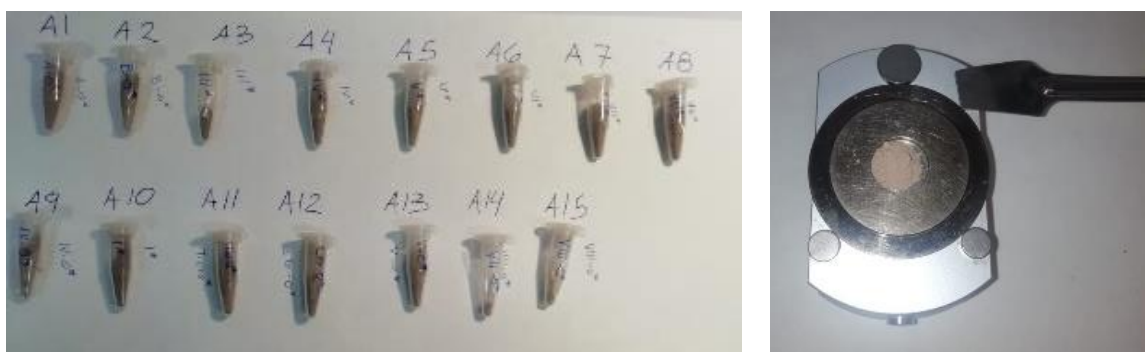
Figura 25: Preparación de muestras de polvo desorientado para DRX.
