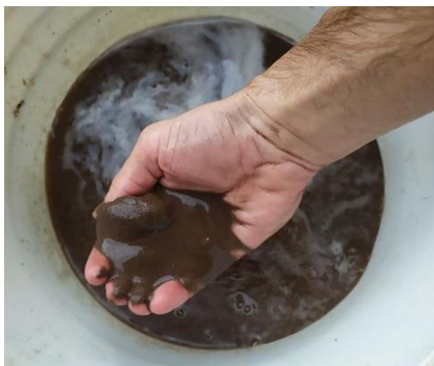
Figura 113: Estado de una probeta de la serie I tras ser sumergida durante 24 hs para la realización del ensayo de absorción de agua por inmersión y resistencia a compresión saturada. Fuente: Elaboración propia.
