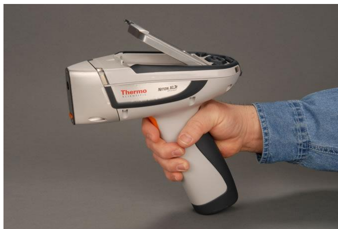
Figura 23: Espectrómetro de fluorescencia de rayos X empleado. Fuente: Catalogo comercial de Thermo Scientific [144].
