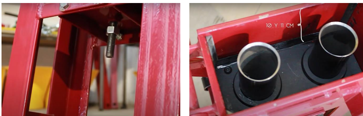
Figura 127: Tornillo que permite subir o bajar el asiento del émbolo y modificar el volumen del molde de una prensa de accionamiento manual. Fuente: Elaboración propia a partir de la página web del fabricante de prensas Julián Zonni [172].
