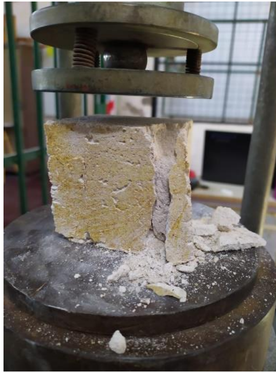
Figura 63: Realización del ensayo de resistencia a compresión sobre una probeta de la serie P-30. Fuente: Elaboración propia.
