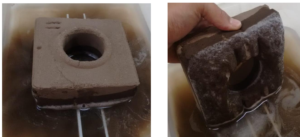
Figura 119: Ensayo de absorción de agua por capilaridad sobre probetas de la serie II. Fuente: Elaboración propia.
