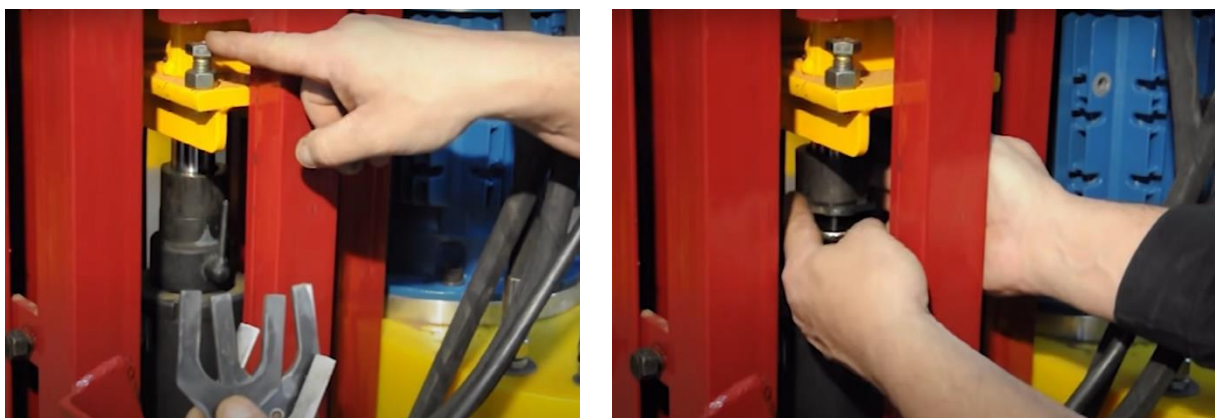
Figura 128: Suplementación con planchuelas metálicas en la parte superior del cilindro de compresión para modificar el volumen del molde de una prensa semiautomática. Fuente: Elaboración propia a partir de la página web del fabricante de prensas Julián Zonni [172].
