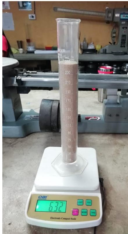
Figura 19: Determinación de la densidad aparente de la tierra. En la balanza puede apreciarse la masa conjunta de la probeta y la tierra. Fuente. Elaboración propia.
