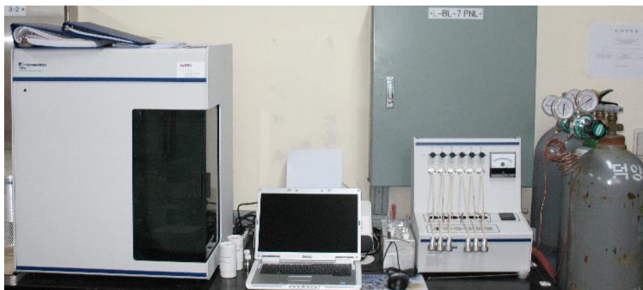
Figura 29: Equipamiento empleado en la determinación de la superficie específica de la materia prima. Fuente: Elaboración propia.
