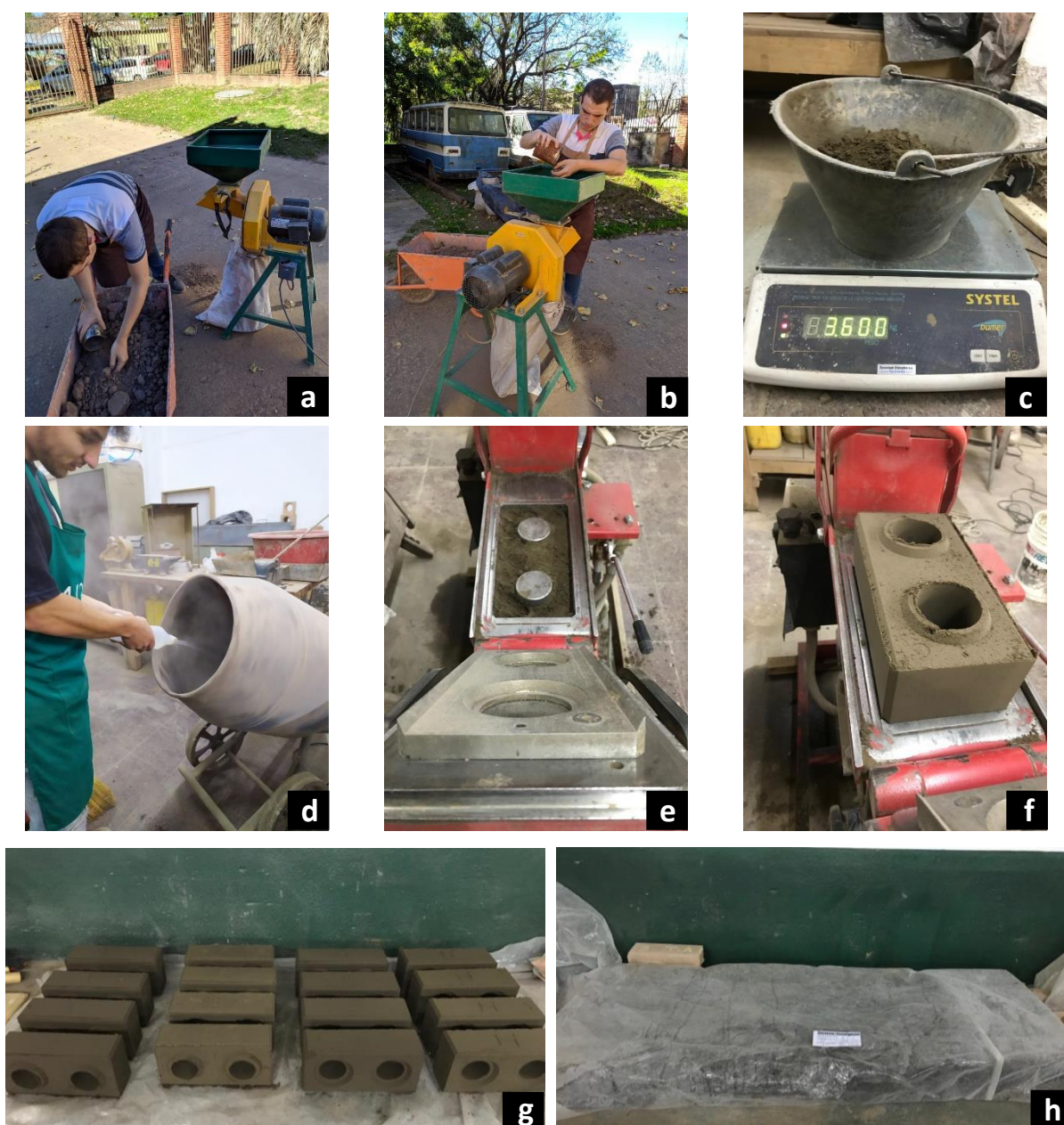
Figura 33: Proceso de fabricación de BTC en el laboratorio de geotecnia de la UTN FRSF. a) Tierra seca antes de ser molida. b) Proceso de molienda de la tierra. c) Dosificación por peso de la materia prima. d) Incorporación del agua por pulverizado dentro de la mezcladora, con ésta en funcionamiento. e) Llenado del molde de la prensa. f) BTC inmediatamente luego de ser prensado. g) Acopio de BTC para ser curados. h) Envoltura de los BTC húmedos con un film de polietileno para favorecer su curado. Fuente: Elaboración propia.
