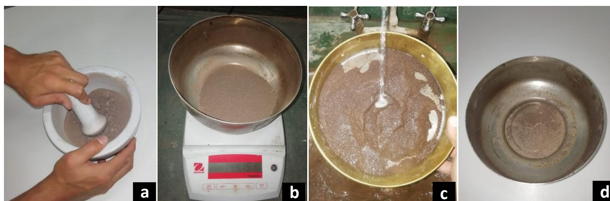
Figura 18: Ensayo de tamizado por vía húmeda sobre una muestra de tierra. a) Desterronado de los conglomerados de arcilla, b) pesado de la muestra, c) realización del tamizado húmedo sobre la malla #200 y d) fracción retenida sobre el tamiz (seca) luego de la realización de ensayo. Fuente: Elaboración propia.
