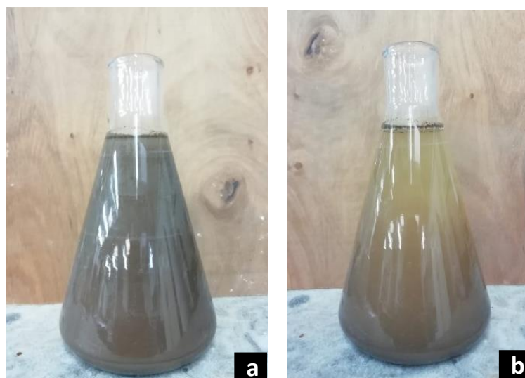
Figura 47: Resultados del ensayo para la determinación del contenido de sales solubles presentes en la tierra luego de a) 1 minuto y b) 24 hs. Fuente: Elaboración propia.
