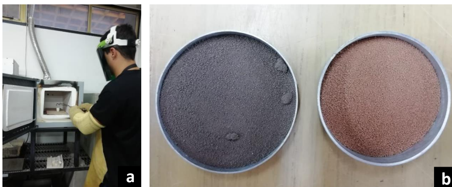
Figura 21: Determinación del contenido de materia orgánica por calcinación. a) Extracción de las muestras de la mufla y b) muestra de tierra antes y después de ser calcinada. Fuente: Elaboración propia.
