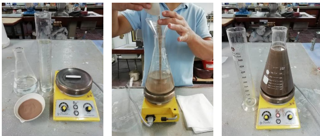
Figura 22: Determinación del contenido de sales solubles totales en muestras de tierra.
