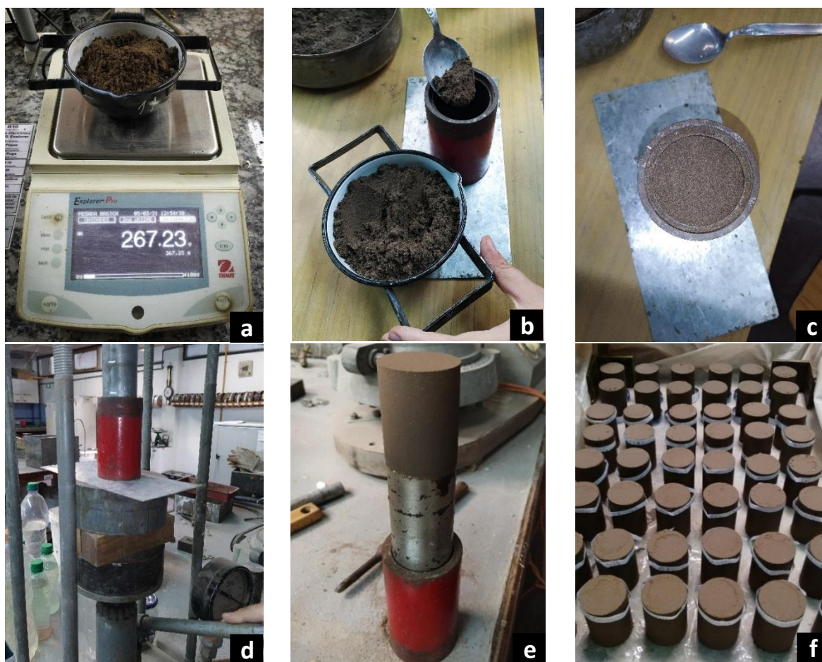
Figura 34: Probetas cilíndricas producidas en laboratorio. Fuente: Elaboración propia.
