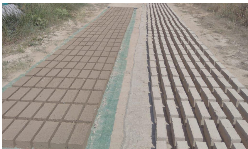
Figura 7: Adobes recién “cortados” (izquierda) y adobes con dos días de antigüedad, volteados de lado para favorecer el proceso de secado (derecha). Fuente: Elaboración propia.
