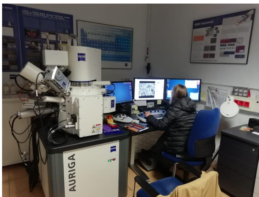
Figura 27: Microscopio electrónico de barrido de emisión de campo del Centro de Instrumentación Científica (CIC) de la UGR. Fuente. Elaboración propia.
