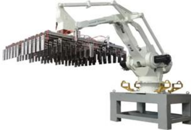
Ilustración 34: Apiladora de ladrillos
