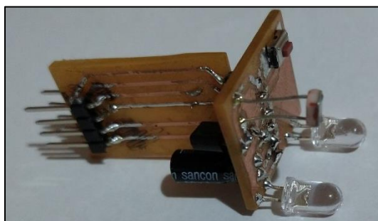
Fig. N° 6.6 Foto real del circuito para los LED de notificación, módulo de interruptores.
