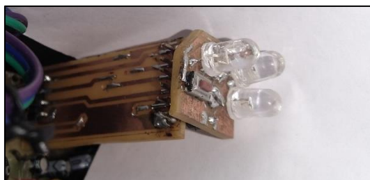
Fig. N° 6.5 Foto real del circuito para los LED de notificación, módulo principal.
