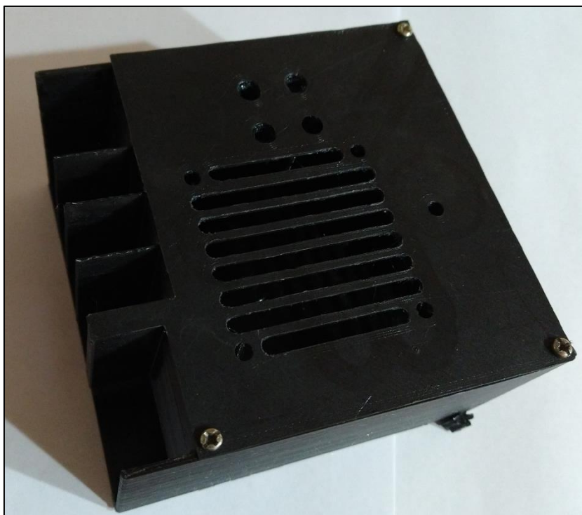
Fig. N° 9.2 Gabinete para el módulo de interruptores.
