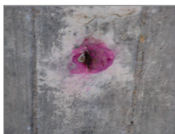
Fig. 8 Vista del primer punto descubierto rociado con solución indicadora.
