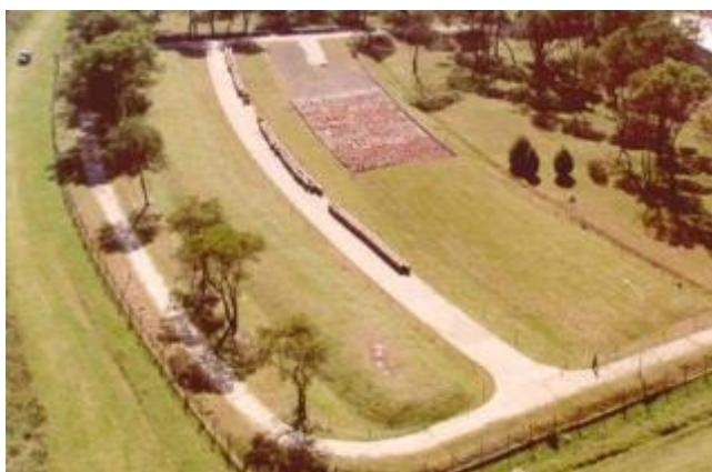
Fig. 3: Residuos de baja y mediana actividad en instalaciones cercanas a la superficie. Trincheras conteniendo tambores con material compactable. (Fuente: Jornadas Argentinas de Protección Radiológica – SAR 2012 – Evaluación de seguridad radiológica de los sistemas de semicontención de residuos radiactivos sólidos del Área Gestión Ezeiza – Expositor: Daniel Tangir [16])
