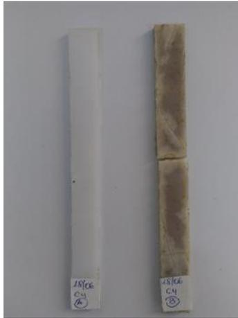
Fig. 38: Probetas de HIPS con lamina de PET adherida.
