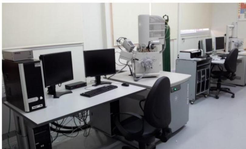
Fig. 33: Microscopio Electrónico de Barrido (SEM – EDAX) marca FESEM – FEI Inspect F50 (CNEA).
