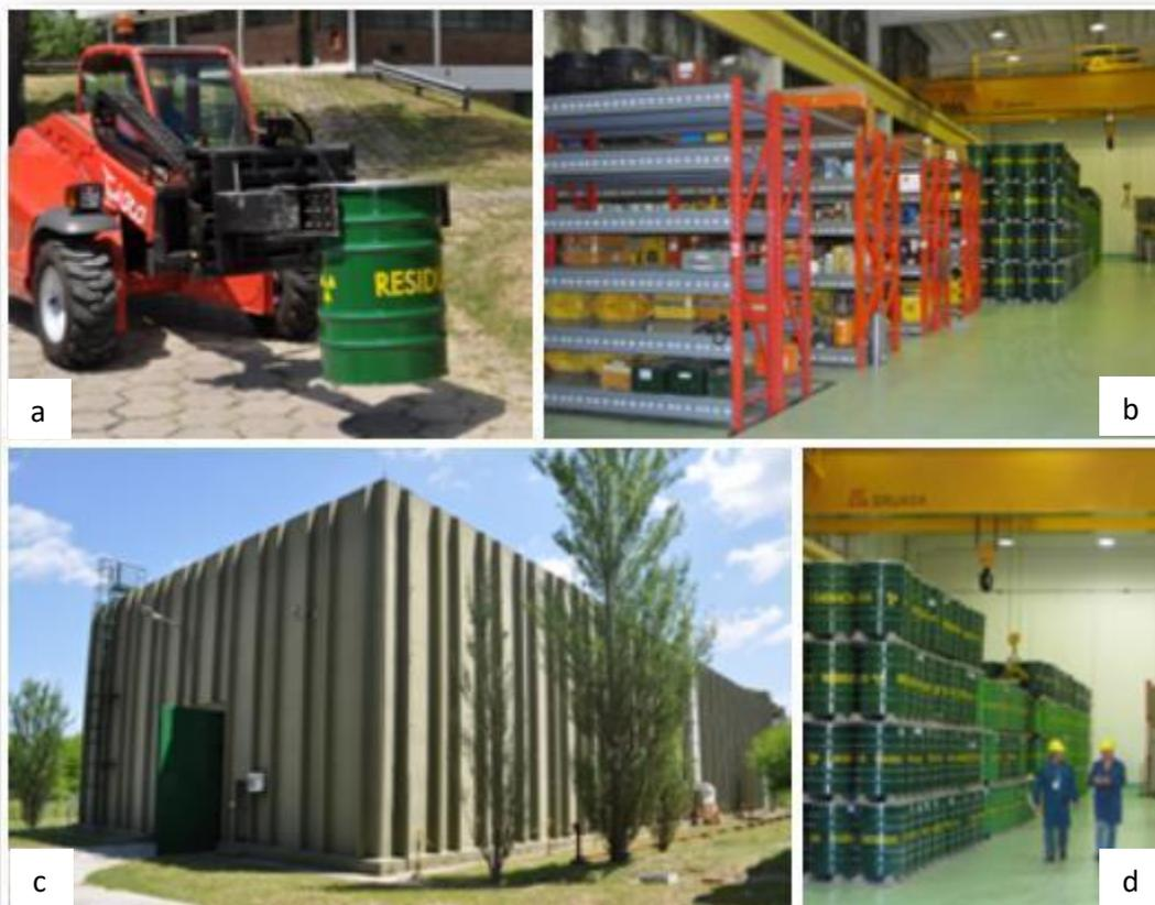
Fig. 2: Residuos de muy baja actividad en instalaciones en superficie. a) Traslado de residuos radiactivos b) fuentes selladas en desuso c) instalación para almacenamiento en superficie d) tambores con material de muy baja actividad. (Fuente: Jornadas Argentinas de Protección Radiológica – SAR 2012 – Gestión de Residuos Radiactivos: Desafíos Actuales. Expositor: Elvira Maset [15])
