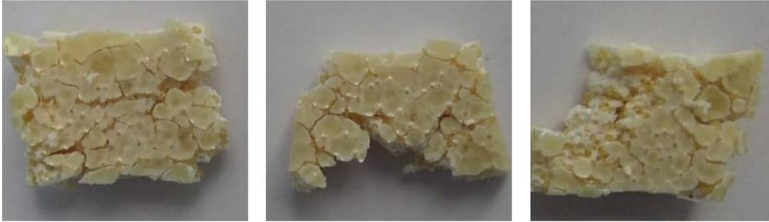
Fig. 61: Probetas de HIPS 30 % e irradiada en ciclo N° 4
