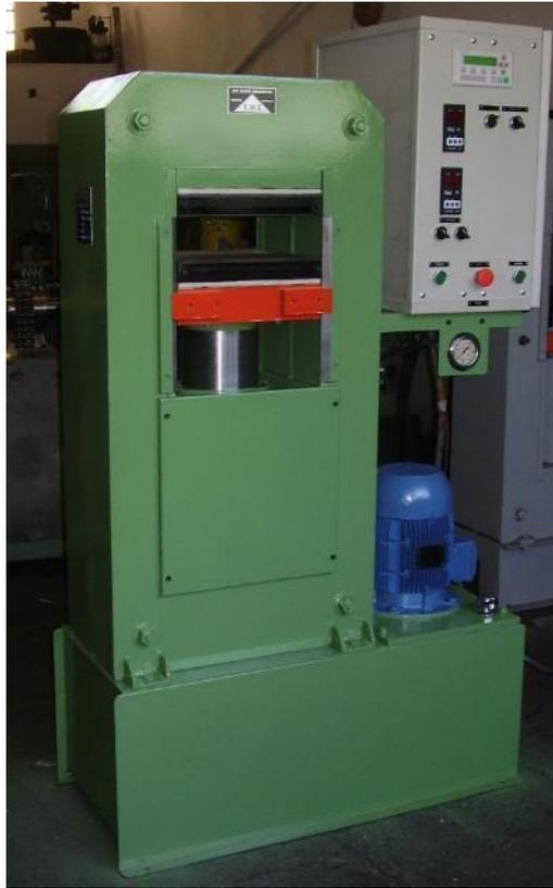
Fig. 28: Prensa hidráulica calefaccionada Smaniotto S.R.L. AMS 160/33 (INTI-Plásticos).
