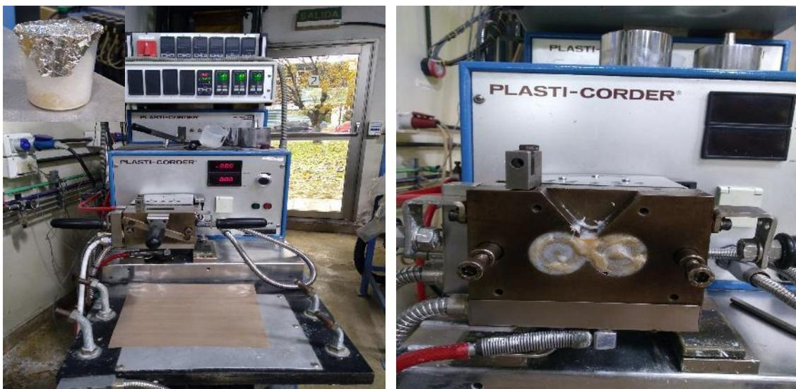
Fig. 27: Mezcladora discontinua Brabender Plasticorder (INTI-Plásticos).
