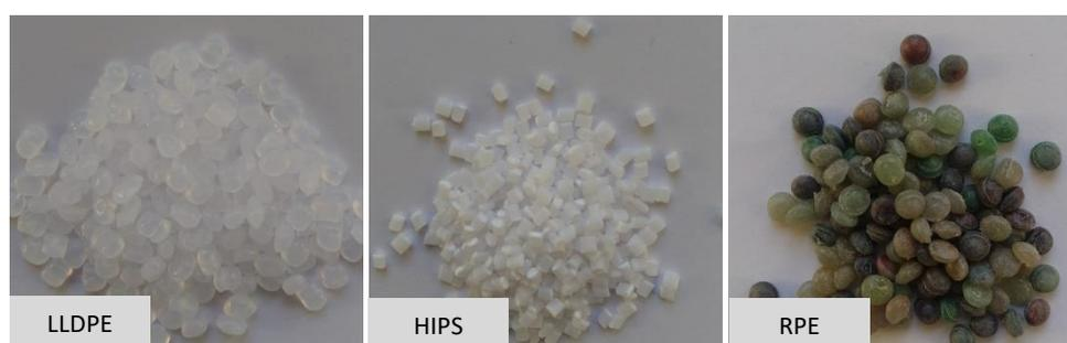
Fig. 26: Pellets de LLDPE, HIPS y RPE empleados en este trabajo.
