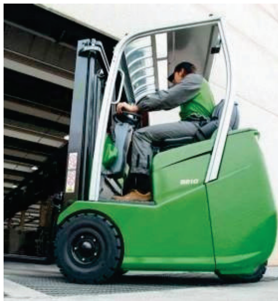
Figura N° 1.3. Carretillas elevadoras eléctricas actuales
