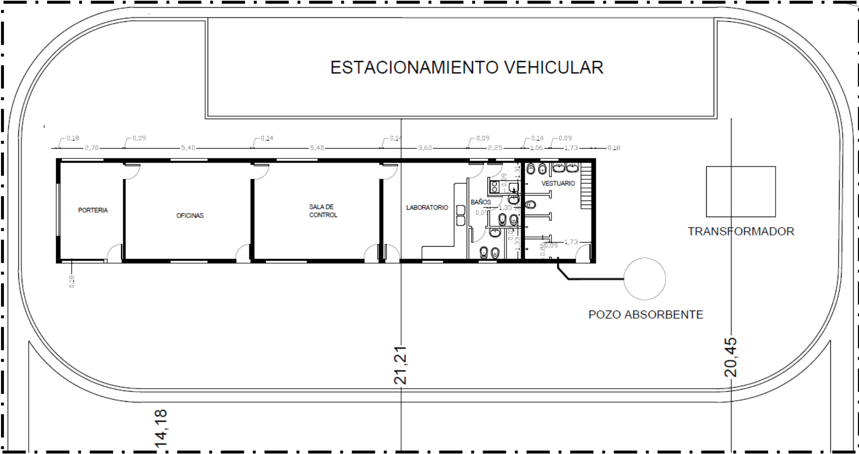
Fig. 86: Detalle de portería, sala de control, laboratorio, baños y vestuario.
