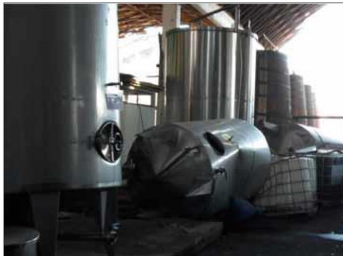
Figura 1 Daño depósitos de vino. Sismo de Chile en 2010. (EERI, 2010)
