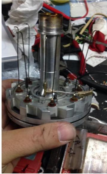
Figura 2 - Circuito de lubricación
