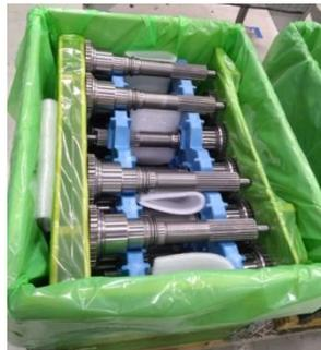
Figura 3 Embalaje de ejes de entrada previo a su ingreso a la cabina de deshumidificación
