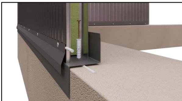
Figura 9a Perfil Z + perfil S para exteriores.
