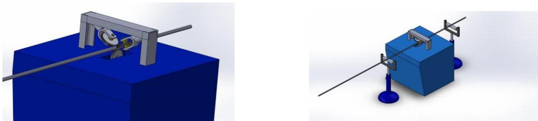
Figura 2 Grabadora de barras y soportes de apoyo.
