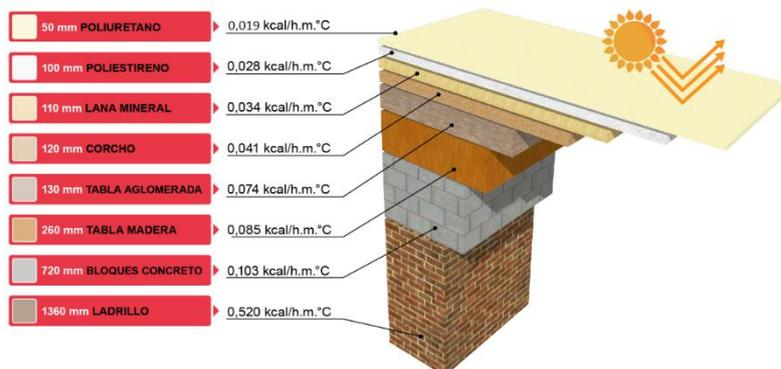
Figura 5 Espesores de muros de distintos materiales con distinta conductividad e igual conductancia térmica.
