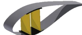
Fig. 5 - Tres celdas con refuerzo superficial entre webs.
