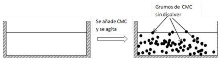
Figura 7 El operario, se dedica a revolver el baño con gran esfuerzo físico y gran inversión de tiempo. A pesar de esto no se consigue disolver la CMC satisfactoriamente, por lo cual queda el baño lleno de grumos, lo cual degrada la calidad del producto final. Se necesita encontrar una solución fácil y económica para este problema.
