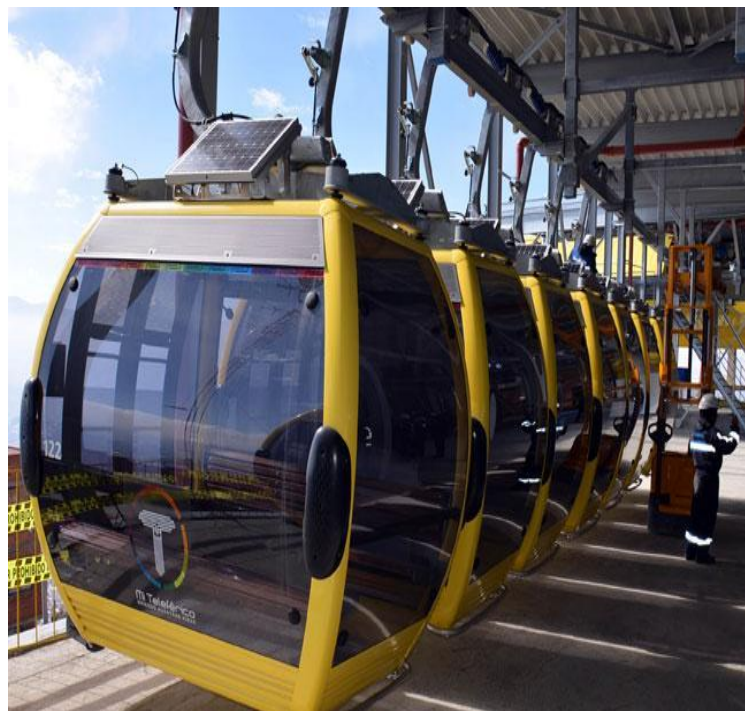
Figura 3.15 Cabina de capacidad para 4 personas
