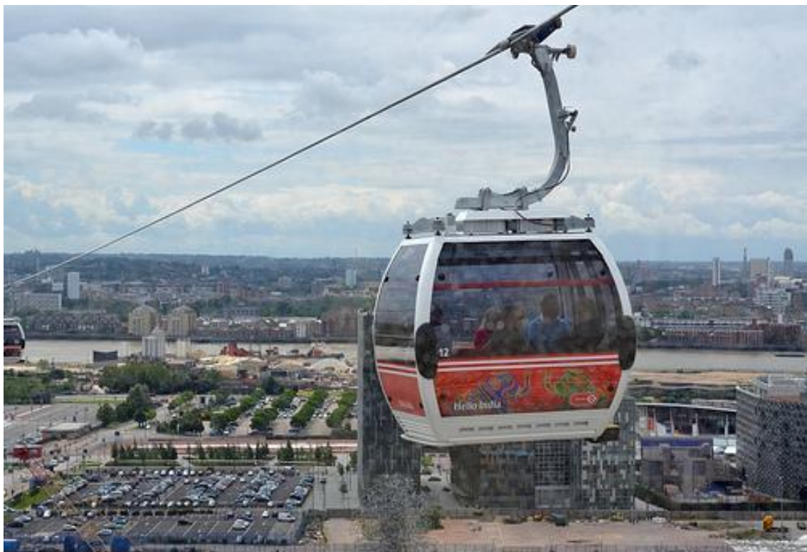
Fotografía 1.11 Sistemas de teleféricos monocables.
