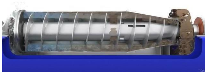
Figura 81. Funcionamiento de Separador helicoidal
