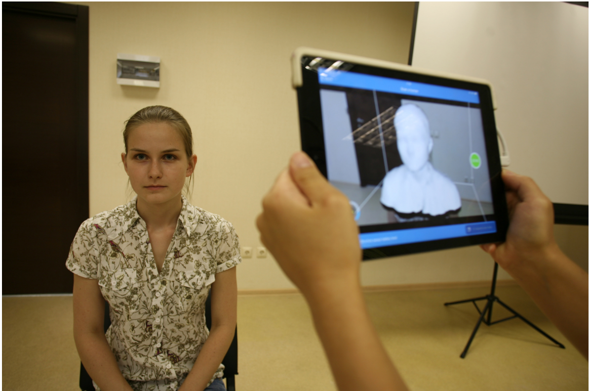
Figura 2.5: Structure Sensor . Escáner basado en triangulación láser ( ItSeez3D ).
