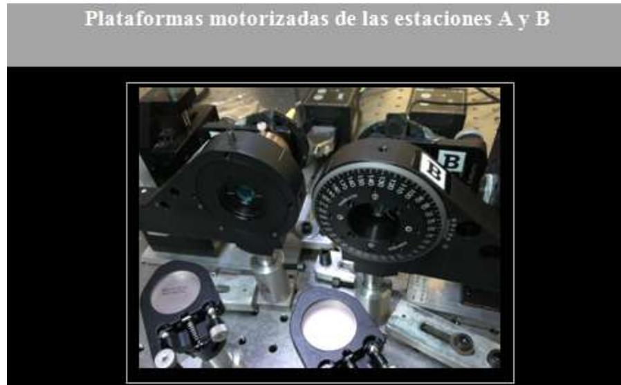
**Figura 50.** Fotografía de plataformas motorizadas de la estación A y B con láminas de media onda montadas.
