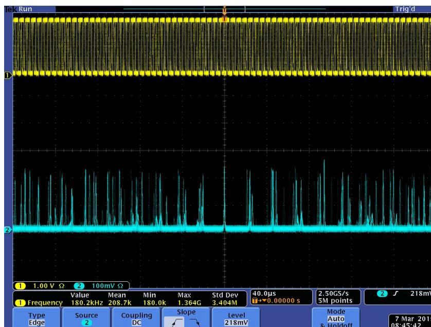
Figura 54. Captura del osciloscopio de la señal de la modulación del láser en color amarillo y salida del láser en color celeste de la medición nro 1.
