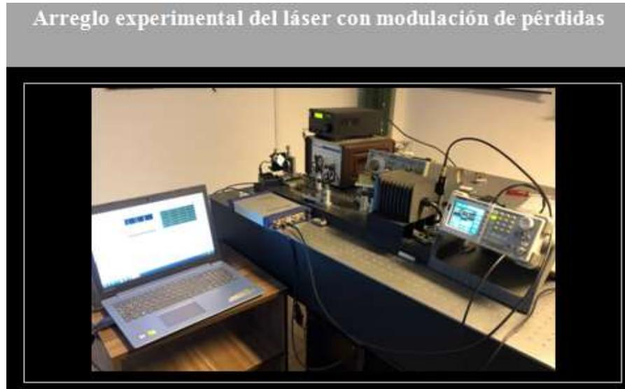
**Figura 55.** Fotografía del arreglo experimental del láser con modulación de pérdidas, adquiriendo con el PicoScope y visualizando la señal con la computadora en tiempo real.
