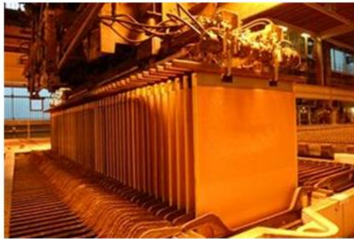
Los cátodos de cobre se cuelgan entre ánodos.
