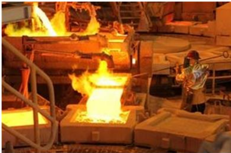
El cobre blíster de la fundición se vierte en los moldes de fundición del ánodo
