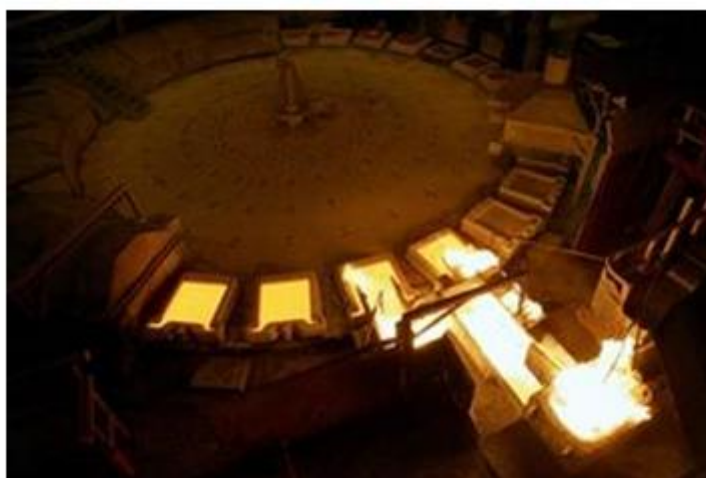
El plato giratorio de fundición del ánodo se mueve lentamente.
