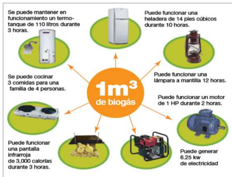
Figura 3. Principales equipos para biogás y sus respectivos consumos. (Varnero Moreno M.T., 2011) y equivalente energético del biogás (Hilbert J.A., 2011)
