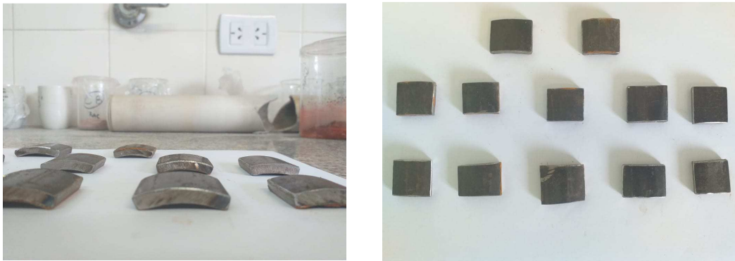
Figura 19. Placas de acero SA-192A utilizadas en el ensayo de fusión de las cenizas sintéticas. Elaboración propia.
