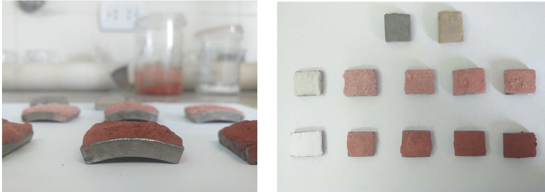
Figura 20. Placas de acero SA-192A utilizadas en el ensayo de fusión de cenizas sintéticas. Elaboración propia.
