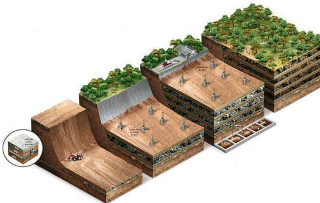
Figura N° 14.1: Explicación de disposición final relleno sanitario. Fuente: (VISE, 2021).
