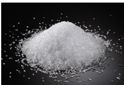
Imagen 3 – Poliestireno virgen en forma de cristal
