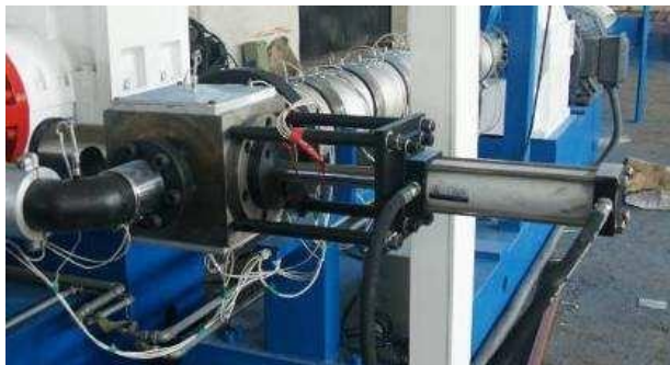
Imagen 21 – Intercambiador de malla
