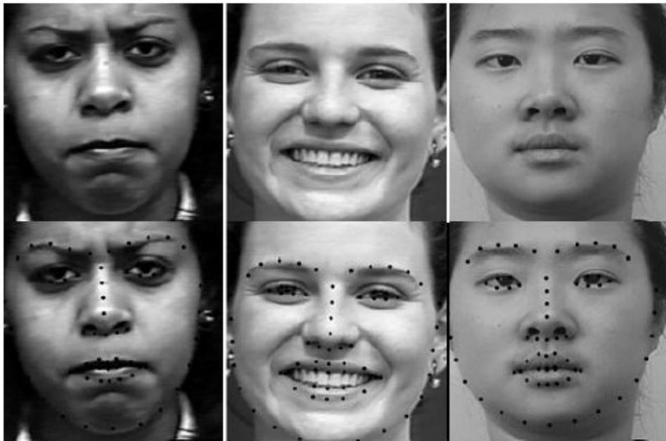
FIGURA 2.18: Puntos encontrados en la cara con la librería dlib.
