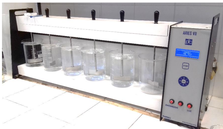
Figura 2.9. Equipo Jar test. . Fotografías: Virginia Martinez.
