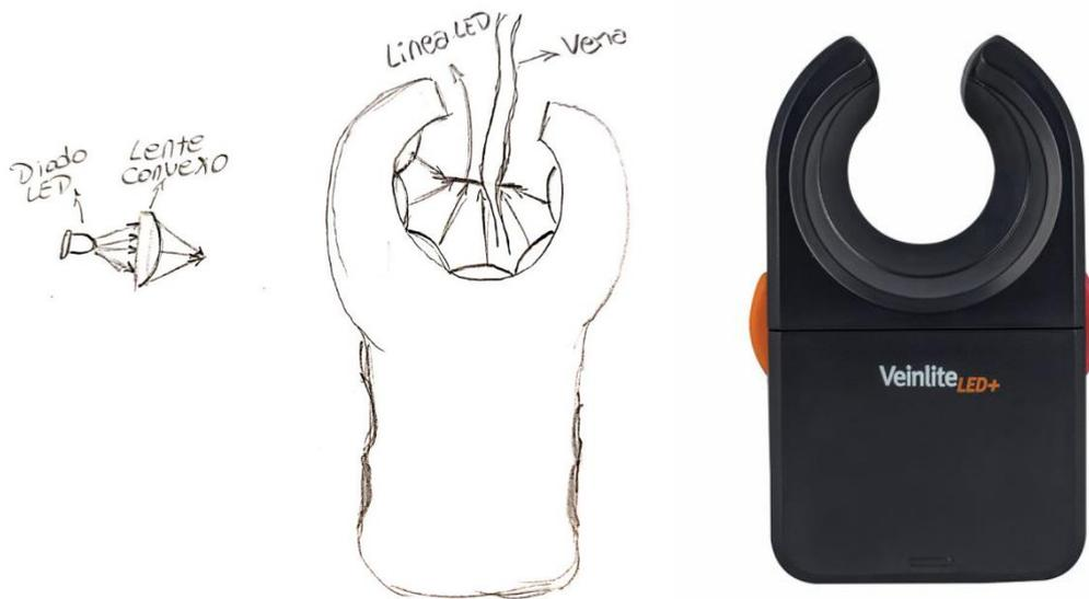
**Figura 19:** Boceto tercera versión V-Find, reemplazando el punto guía por una línea y adaptando para ser utilizado con la mano inhábil. A la derecha, Veinlite LED+, producto comercial con un diseño similar
