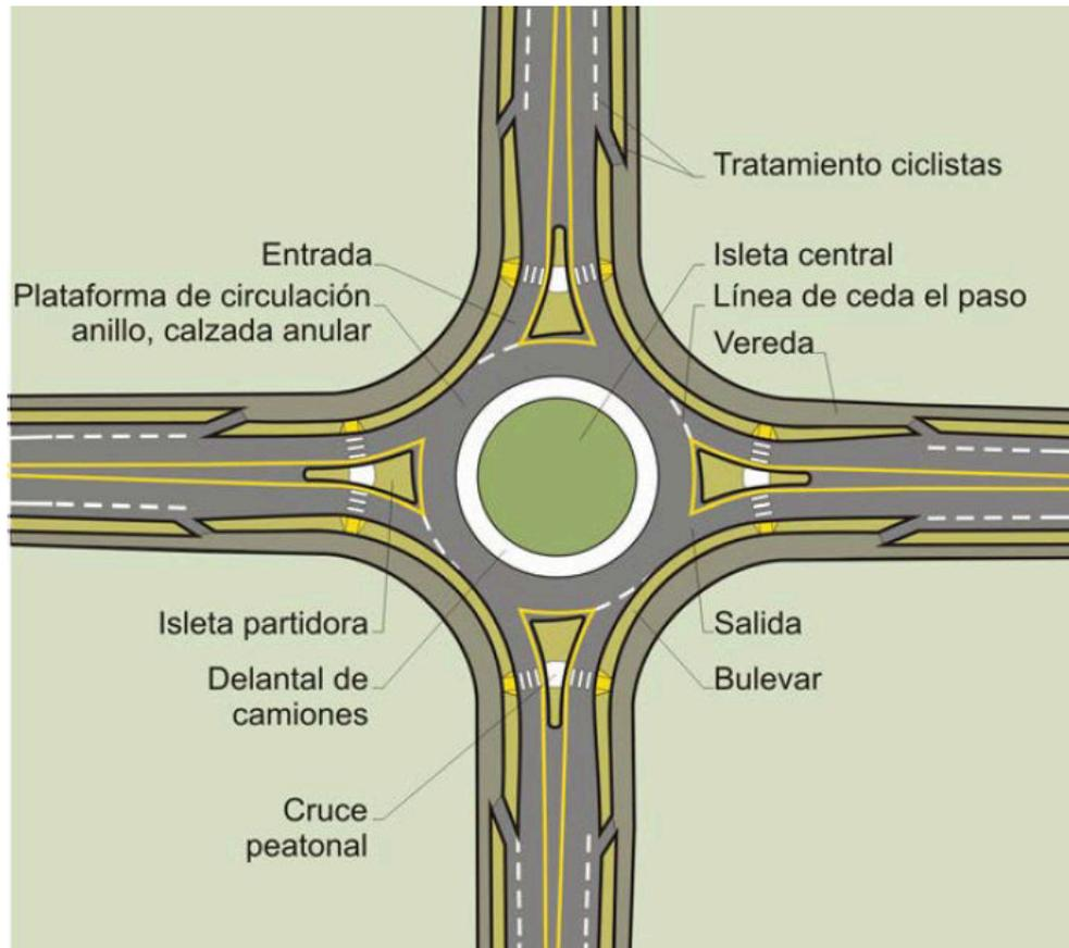
Ilustración 4.69 | Elementos Rotonda Circular Moderna
