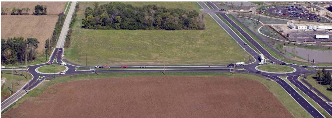
Ilustración 4.67 | Ejemplo de Rotondas Circulares
