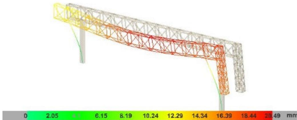
Ilustración 7.68 | Deformación Peso Propio Carga Muerta Sobrecarga y Viento V2 Viga Principal
