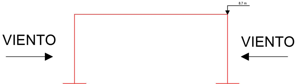
Ilustración 7.17 | Esquema de Análisis Viento Perpendicular a la Pendiente de Techo.
