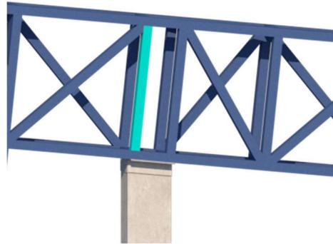
Ilustración 7.28 | Montante Plano Vertical Viga Principal.
