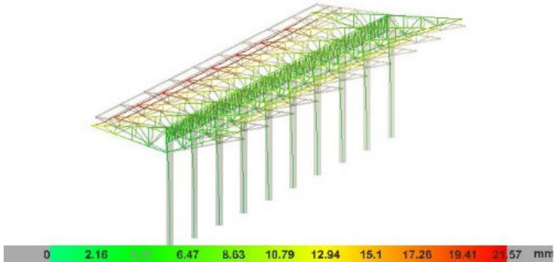
Ilustración 7.73 | Deformación global de la estructura del Semicubierto debido a cargas gravitatorias e hipótesis 2 de viento.
