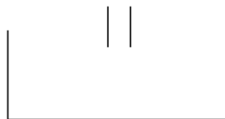
Imagen 11.1 Símbolo gráfico depósito de fluido hidráulico
