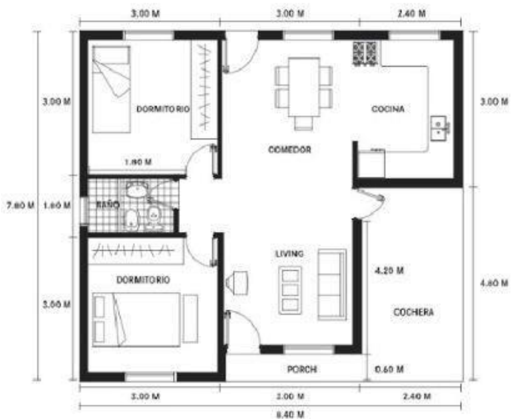
PLANO VENECIA MODELO N° 1060 MEDIDAD EXTERIORES EN METROS. Altura Cielorraso 2.40 m
