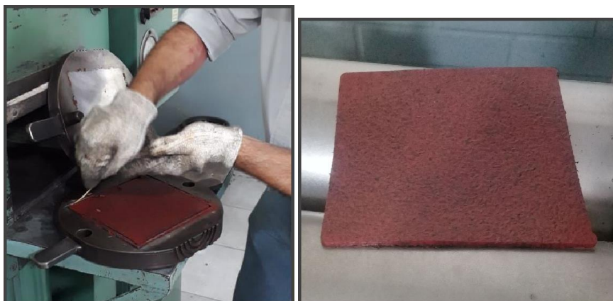
Figura 5.16. Desmolde. Fuente Propia
