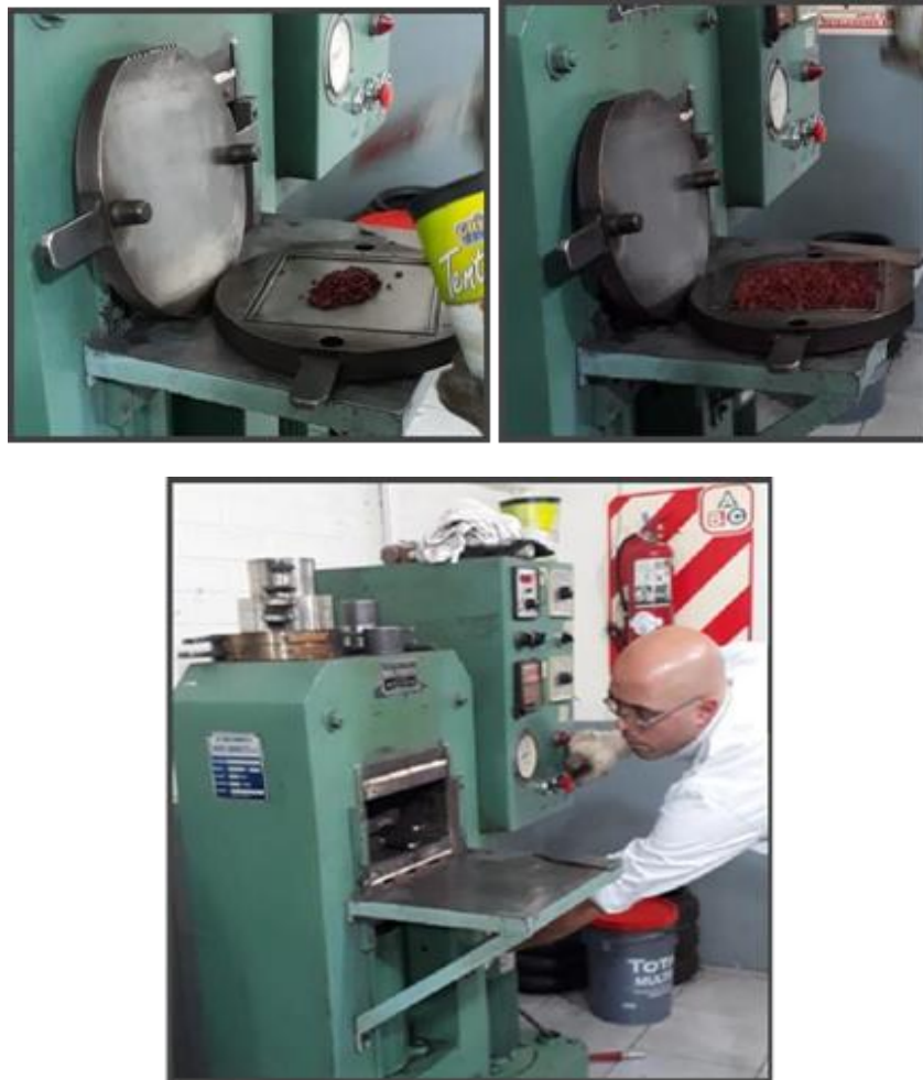
Figura 5.15. Llenado de molde y Prensado. Fuente Propia
