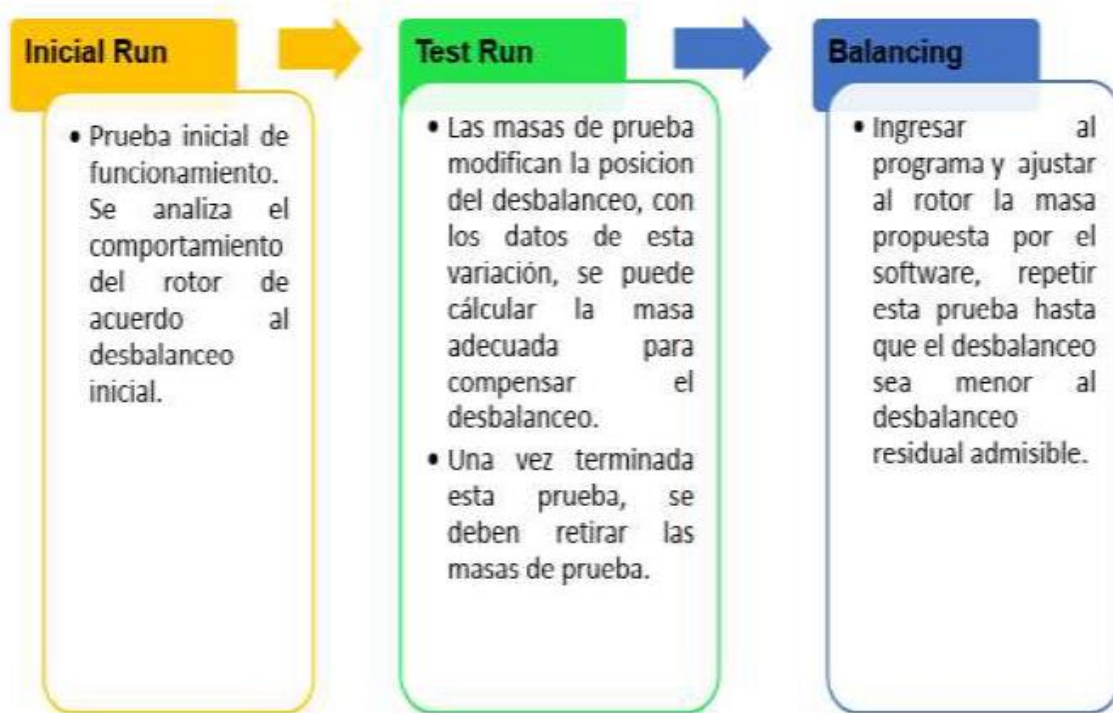
Imagen 7-3 Metodología de trabajo en balanceo de rotores
