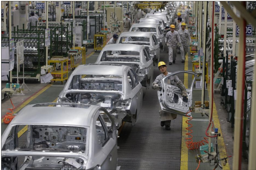
Figura 7.2: Ejemplo de proceso discreto – línea de ensamblaje.
