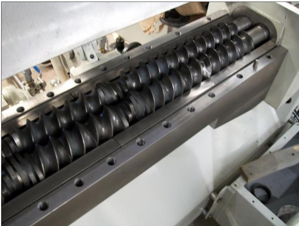
Figura 2.16: Vista interna de máquina extrusora de doble tornillo.
