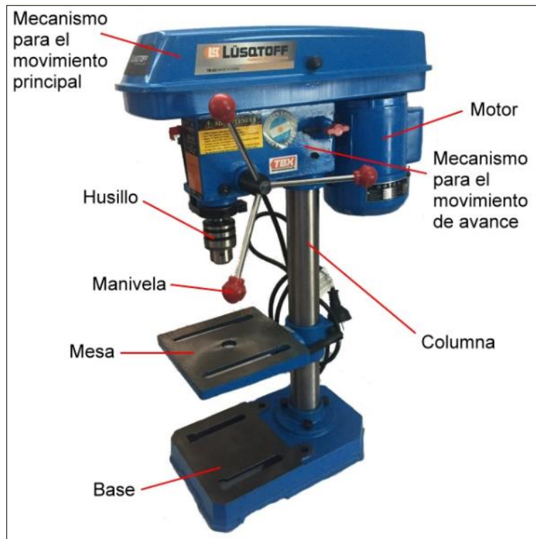
Figura 7.7: Partes principales de un taladro de banco.
