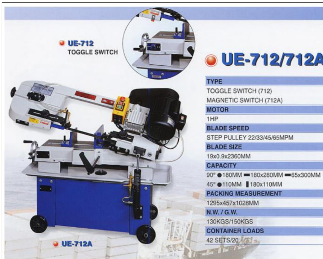
Figura 7.13: Sierra sin fin para metales.
