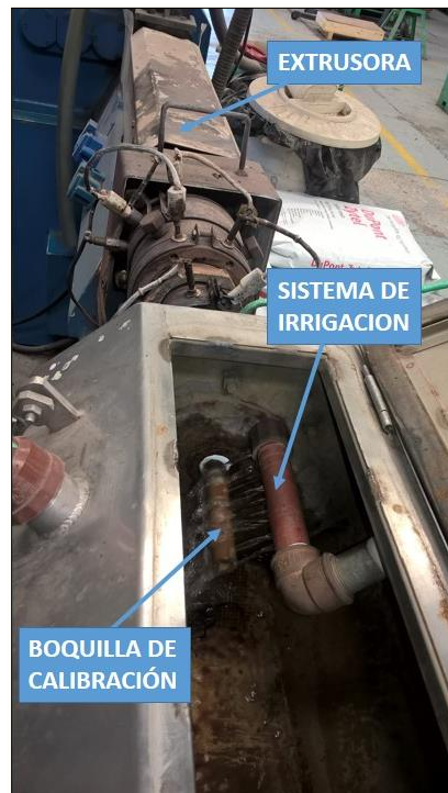
Figura 2.35: Boquilla de calibración e irrigación inicial.
