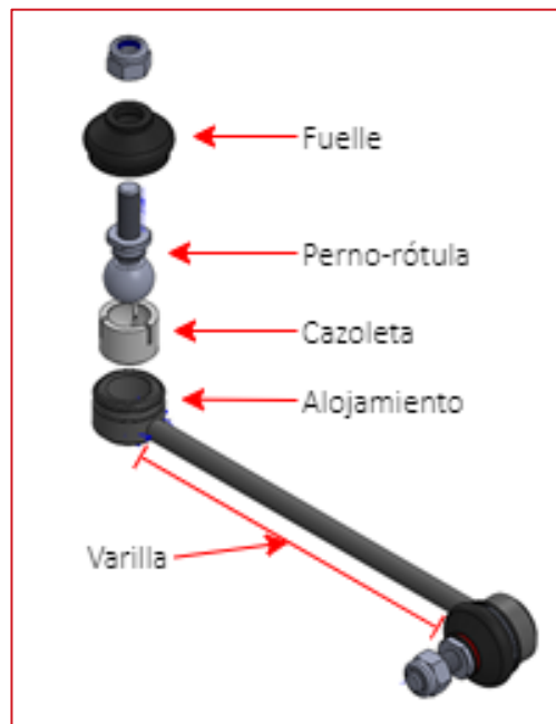
Figura 22: Componentes de una bieleta estabilizadora estándar
