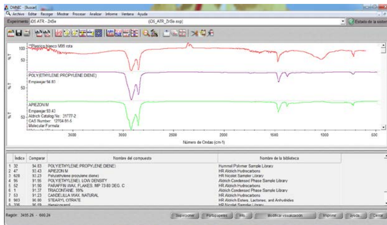
Spectro resultante de la sustracción del espectro original y el espectro obtenido del plástico blanco de la loseta SP99 rota, la identificación del material dio igual al del espectro original. Polietileno Propil Dieno.
