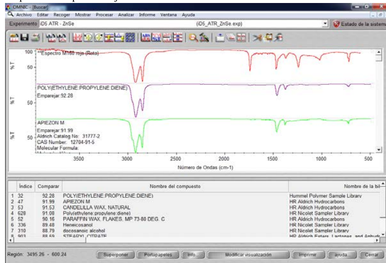
Espectro IR de plástico rojo extraído de la loseta SP160 rota
