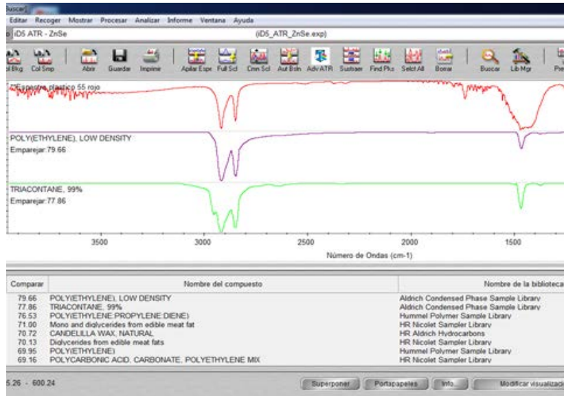
Espectro IR de plástico rojo extraído de la loseta SP55
