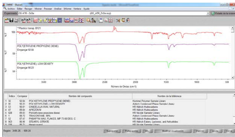
Espectro IR plástico transparente extraído de loseta SP121
