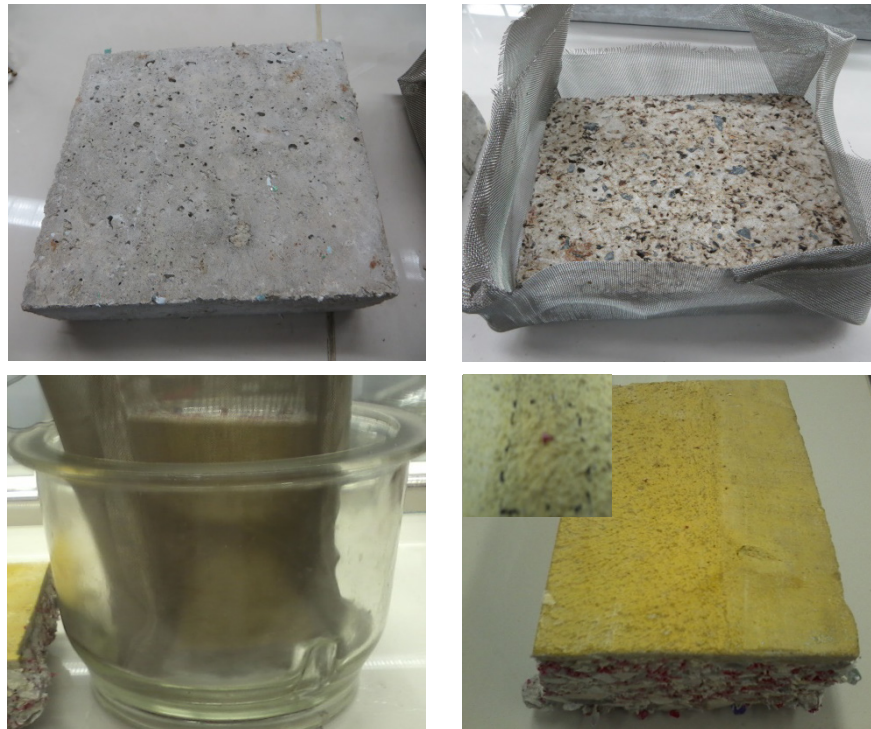
Figura N° IV.19. Vista del dispositivo contenedor de la loseta en el ataque con Na 2 SO 4 , vista de la superficie, atacada y sin atacar del mortero, vista ampliada de la superficie atacada en el mortero.
