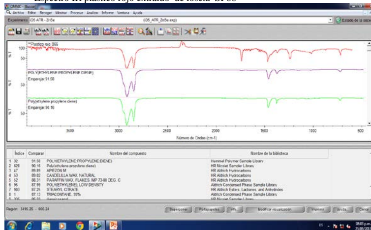
Espectro IR plástico rojo extraído de loseta SP66
