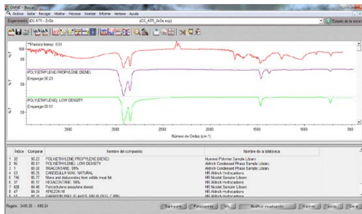
Espectro IR plástico transparente extraído de loseta SP33
