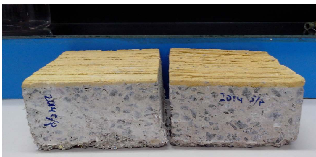
Figura Nº V.1. Corte de la loseta, los puntos blancos, en la loseta izquierda, son el copolímero agregado.
