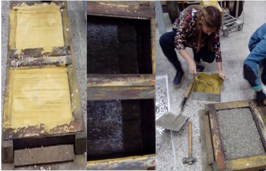
Figura N° V.8. Molde humectado y Molde relleno de hormigón, con y sin copolímero
