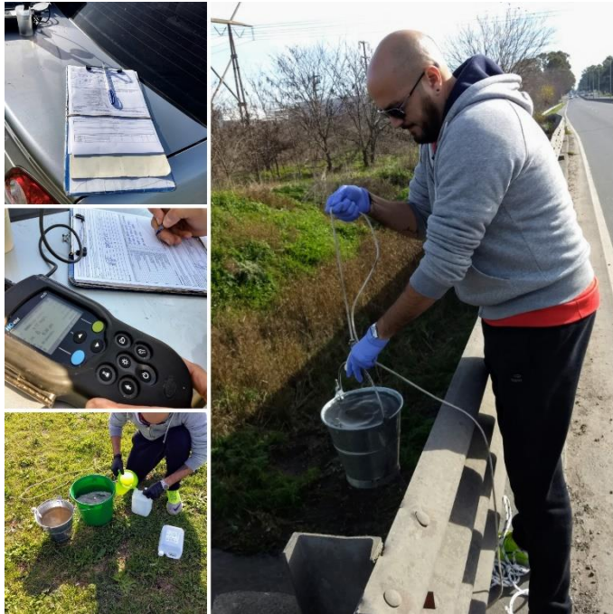
ILUSTRACIÓN 3-ELEVACIÓN DE MUESTRA DESDE EL PUENTE DE LA AV. CALCHAQUÍ (ESTACIÓN MONITOREO M3), TRASVASO Y REGISTRO.
