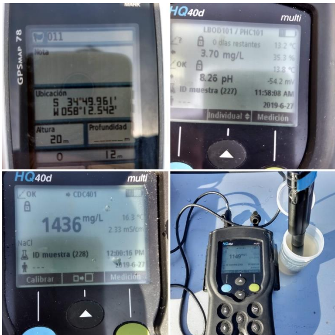
ILUSTRACIÓN 4- EQUIPO MULTIPARAMÉTRICO HACH HQ40D UTILIZADO EN CAMPO
