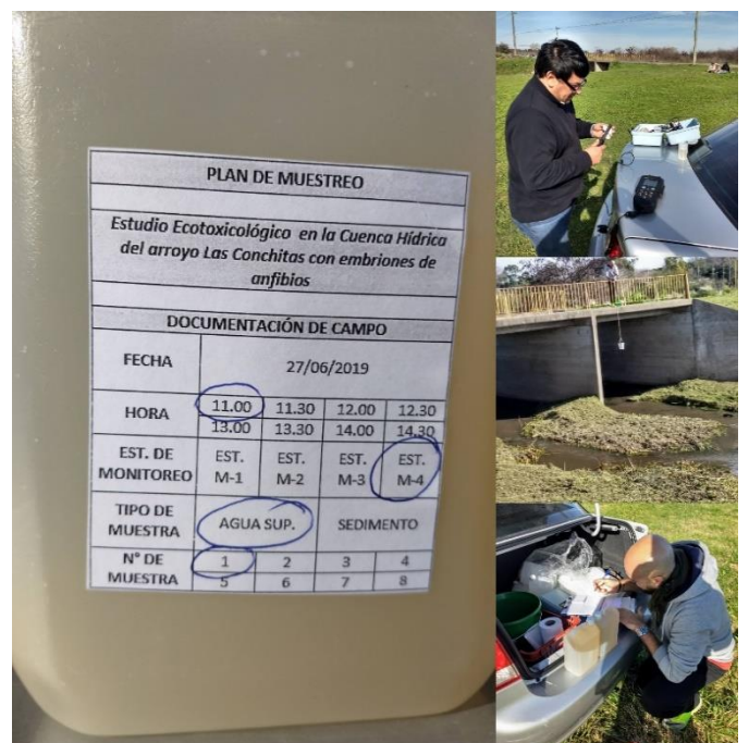
ILUSTRACIÓN 1- MUESTRA ENVASADA Y ROTULADA EN CAMPO (ESTACIÓN DE MONITOREO M4). ELEVACIÓN DE MUESTRA, REGISTRO Y LIMPIEZA DE EQUIPO MULTIPARAMÉTRICO.
