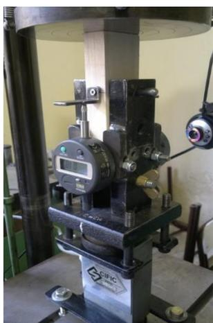
Figura 1 : Probeta y dispositivo de ensayo UTN FRVT
