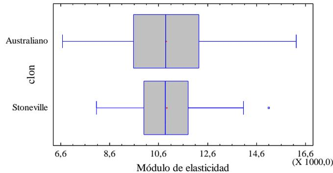
Figura 8: Módulo de elasticidad en  $N/mm^2$
