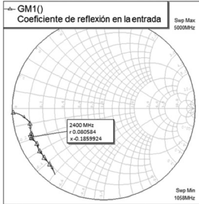
**Fig. 2. Coeficiente de reflexión en la entrada del transistor**
